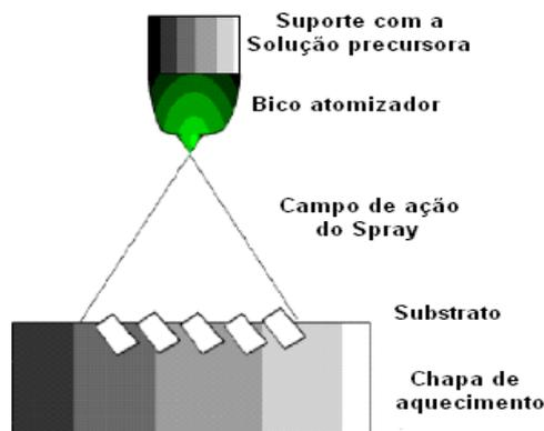
Figura 3: Esquema do sistema de deposição pelo método de Spray-Pirólise (Fonseca, 2006).
