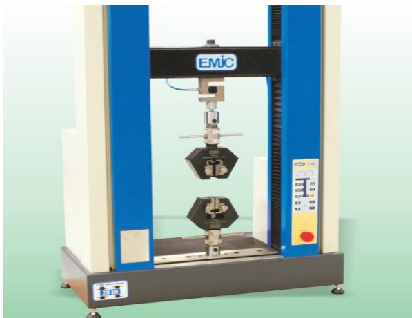
Figura 16 – Máquina de ensaio universal EMIC, no modo de tração. (EMIC, 2013).
