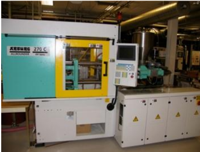
Figura 15 – Imagem da Injetora utilizada para o molde dos corpos de prova. (MBI, 2013).
