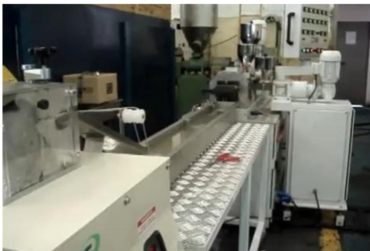
Figura 14 – Imagem de uma extrusora, acoplada a uma peletizadora (IMA, 2013).
