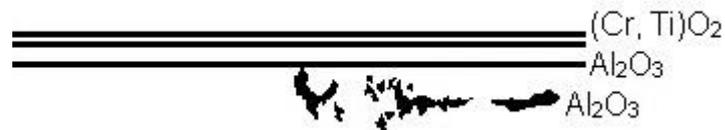
Figura 6.5 – Esquema representativo de uma das morfologias observadas para a liga IN738LC.
