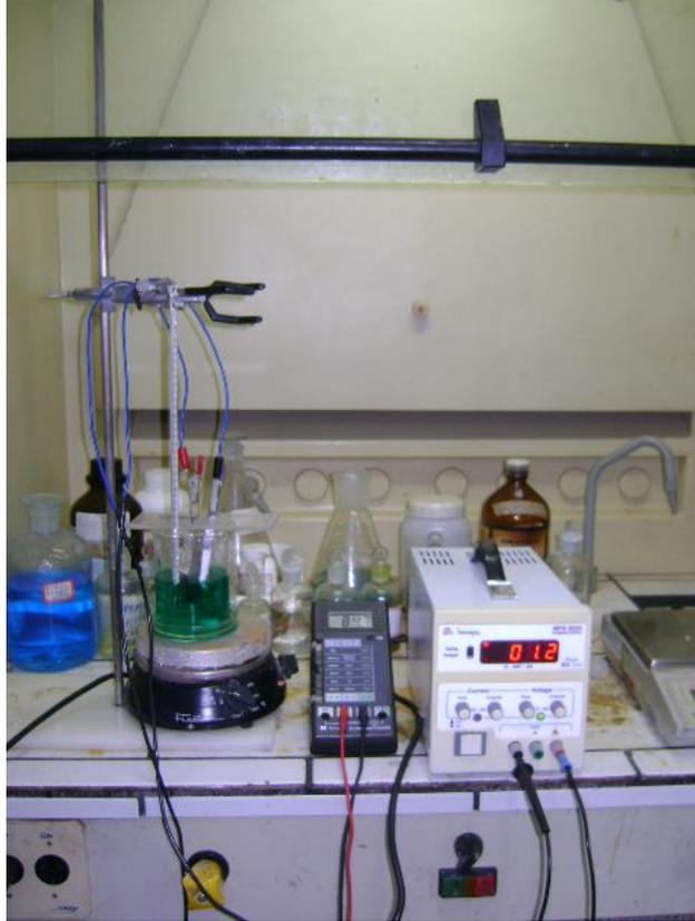
Figura 3.7 – Foto ilustrativa do aparato utilizado no processo de eletrodeposição de níquel sobre a superfície dos corpos de prova após os testes de oxidação.
