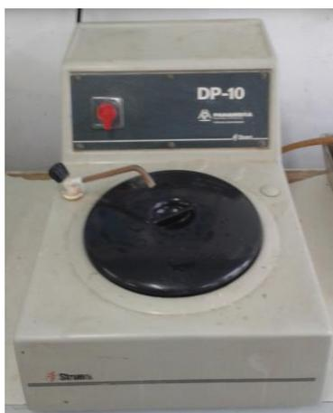
Figura 3.2 – Politriz modelo DP10, fabricada pela STRUERS.
