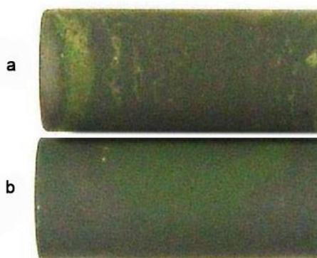
Figura 4.1 – Corpos de prova após o ensaio de oxidação, à temperatura de 900°C, por 300h. a) IN738LC e b) IN939
