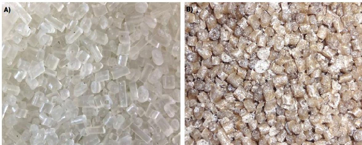
Figura 25- Pellets do PP puro (a) e dos Compósitos com 20% de fibras(b).
