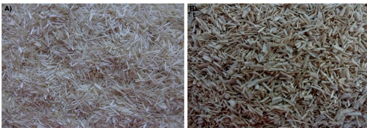
Figura 20- Aspectos visuais das fibras do bagaço de cana de açúcar: (a) Não tratadas (b) Tratadas.
