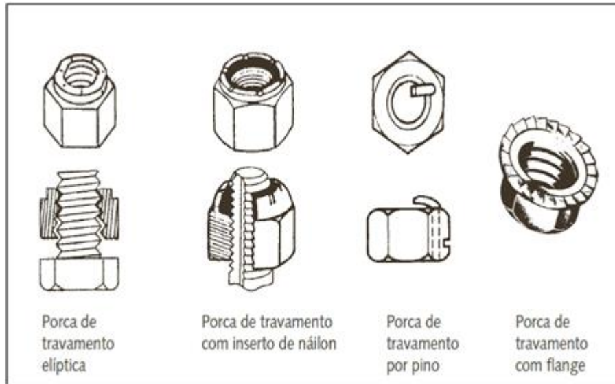
Figura 2.5 – Tipos de Porcas (Fonte: Norton, 2013)
