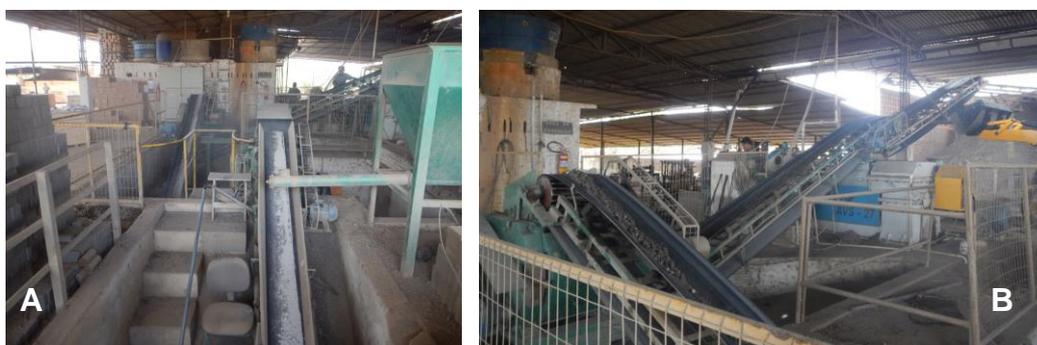
Figura 42. (A) Material saindo do caixão alimentador, (B) Matérias-primas na esteira, em direção à maromba. Fonte: Acervo da autora.
