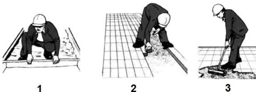
Figura 17. Sistema construtivo do pavimento de adoquim. Em 1- Criação da base de areia; 2- Assentamento das peças; 3- Fechamento das juntas com areia. Fonte: MALPESA (2015), modificado.
