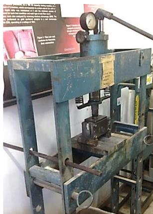
Figura 40. Prensa utilizada para a produção dos corpos de prova. Fonte: Acervo da autora.
