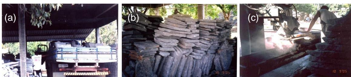
Figura 30. (a) Chegada e (b) Armazenamento das lajes de granito na serraria. (c) Serragem das lajes. Fonte: Acervo da autora.
