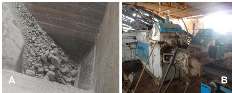
Figura 43. (A) Caixa alimentador com as matérias-primas (B) Maromba utilizada no processo. Fonte: Acervo da autora.
