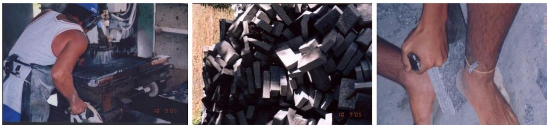
Figura 31. (a) Serragem das lajes. (b) Blocos provenientes da serragem das lajes. (c) Operação manual de corte para obtenção de lajinhas. Fonte: Acervo da autora.
