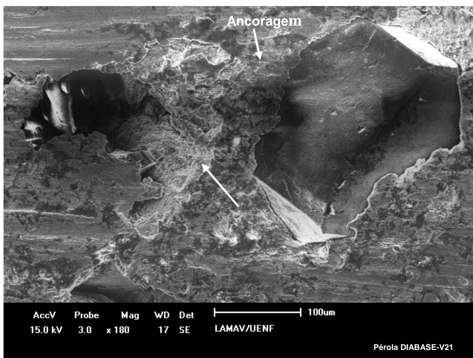
Figura 4.58 – Morfologia de desgaste abrasivo do compósito DIABASE-V21, com fechamento de pull-out, após 12 minutos de ensaio de abrasão.
