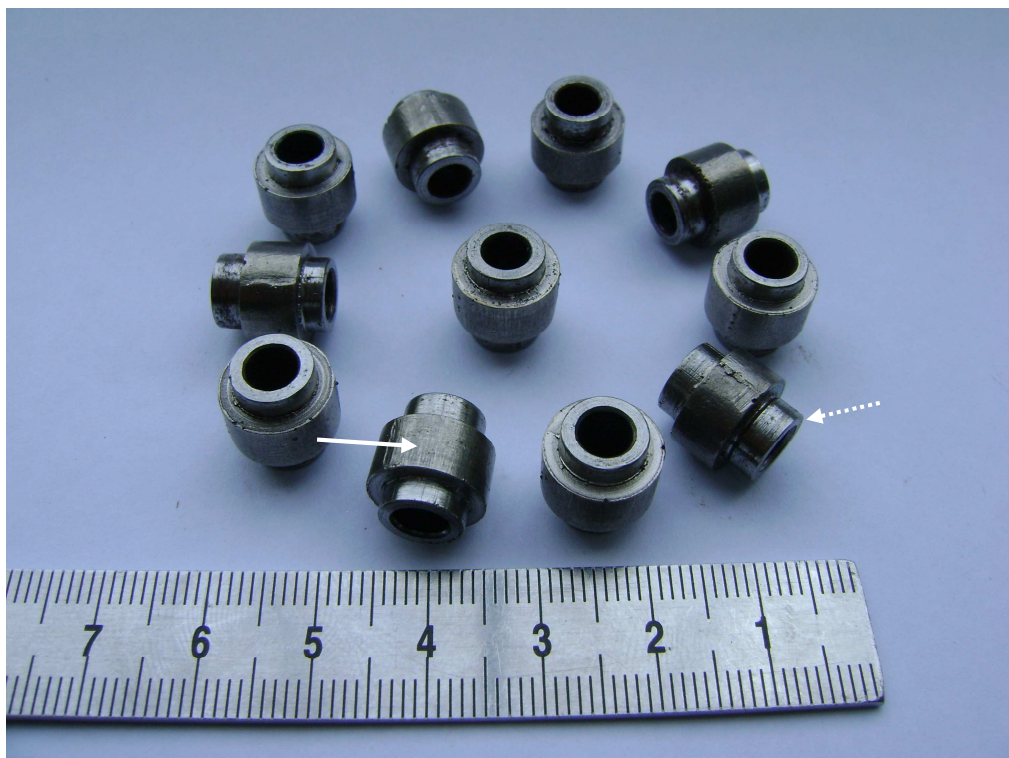
Figura 4.2 - Aspecto dimensional das pérolas produzidas por este trabalho com a liga metálica DIABASE-V21 (escala em mm).
