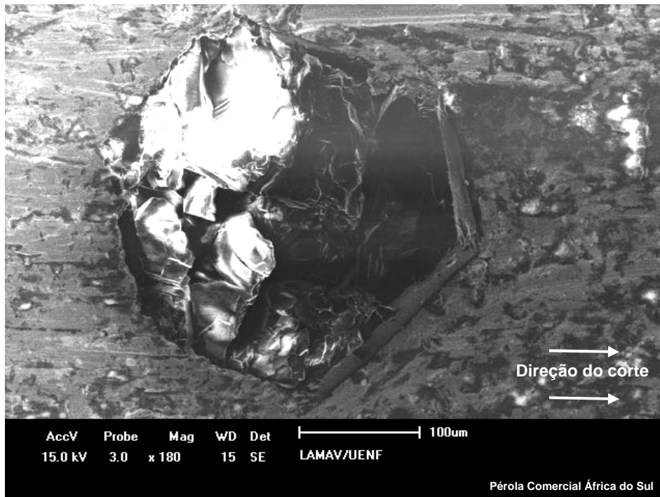
Figura 4.80 – Morfologia do desgaste por clivagem dos diamantes na matriz metálica Cu-Fe-Zn-Sn-Ni (pérola comercial África do Sul), após 12 minutos de ensaio de abrasão.
