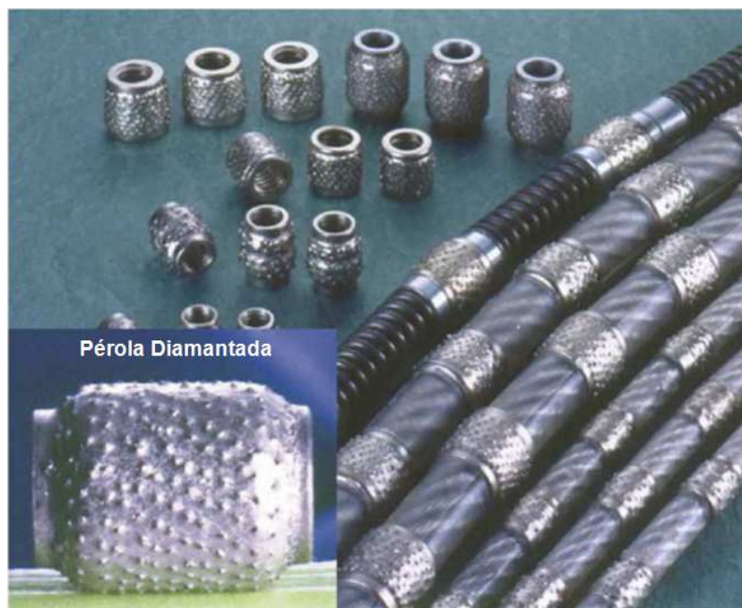
Figura 2.4 - Pérolas e fios diamantados com sistemas de espaçamento por molas (para corte mármore) e por plástico moldado por injeção (corte de granito) [Sung et al., 2009].
