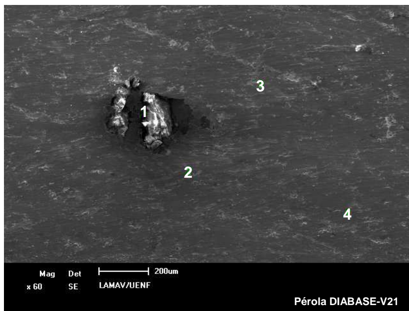
Figura 4.11 - Microestrutura da liga Fe-Cu-Co-Sn (DIABASE-V21), com identificação da região da microanálise pontual por EDS.
