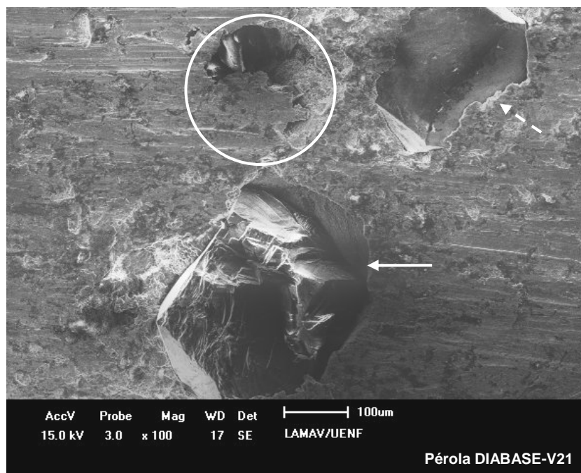
Figura 4.6 - Micrografia mostrando vários estágios de desgaste do composto diamantado DIABASE-V21, após 12 minutos de ensaio de abrasão.
