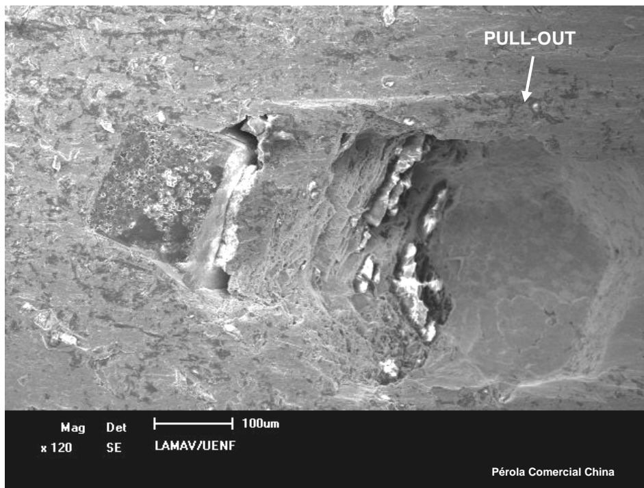
Figura 4.62 - Estrutura do diamante “pull-out” na matriz metálica Fe-Ni-Cu-Zn-Sn-Mn (pérola comercial China), após 2 minutos de ensaio de abrasão.
