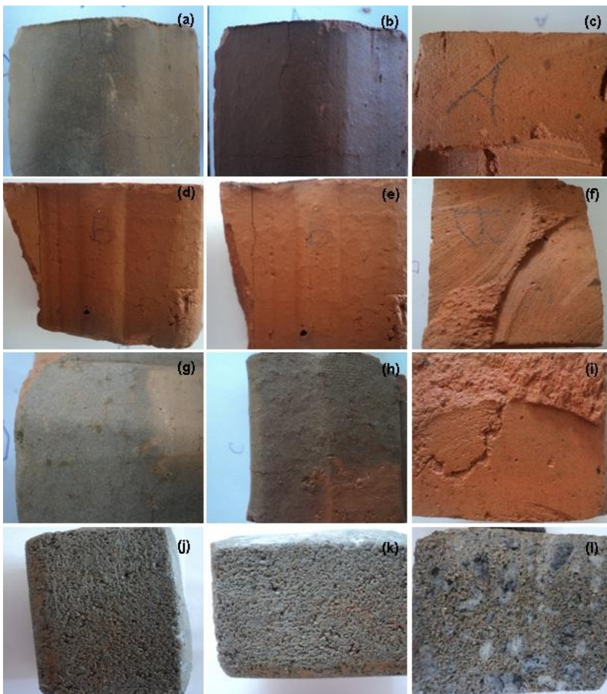
Figura 5.59. Corpos de prova após ensaio de ataque químico com Cloreto de amônio (100g/L). (a) antes de ensaio, (b) após o ensaio, lado “A”, (c) após o ensaio, lado “B”; (d) antes de ensaio, (e) após o ensaio, lado “A”, (f) após o ensaio, lado “B”; (g) antes de ensaio, (h) após o ensaio, lado “A”, (i) após o ensaio, lado “B”; (j) antes de ensaio, (k) após o ensaio, lado “A”, (l) após o ensaio, lado “B”.
