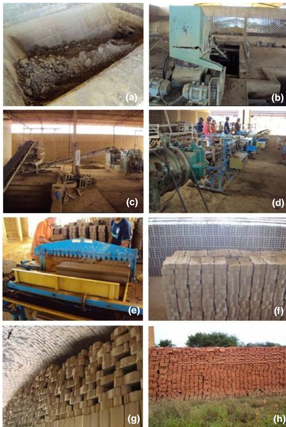
Figura 4.5. Processamento industrial do adoquim. Dosagem das matérias-primas (a), desagregação (b), laminação (c), extrusão (d) e (e), secagem (f) e (g) e queima (h).
