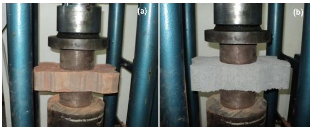
Figura 4.6. Ensaio de resistência mecânica (a) adoquim e (b) PPC .
