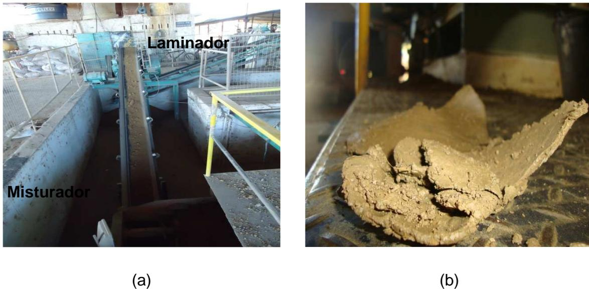
**Figura 4.15 - Processo de Laminação das massas (a) Massa cerâmica AM1 saindo do misturador para o laminador por esteira e (b) Massa AM5 laminada**
