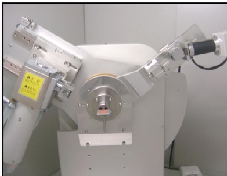
**Figura 3.2 - Difratômetro de raios-x modelo XRD700, marca SHIMADZU.**
