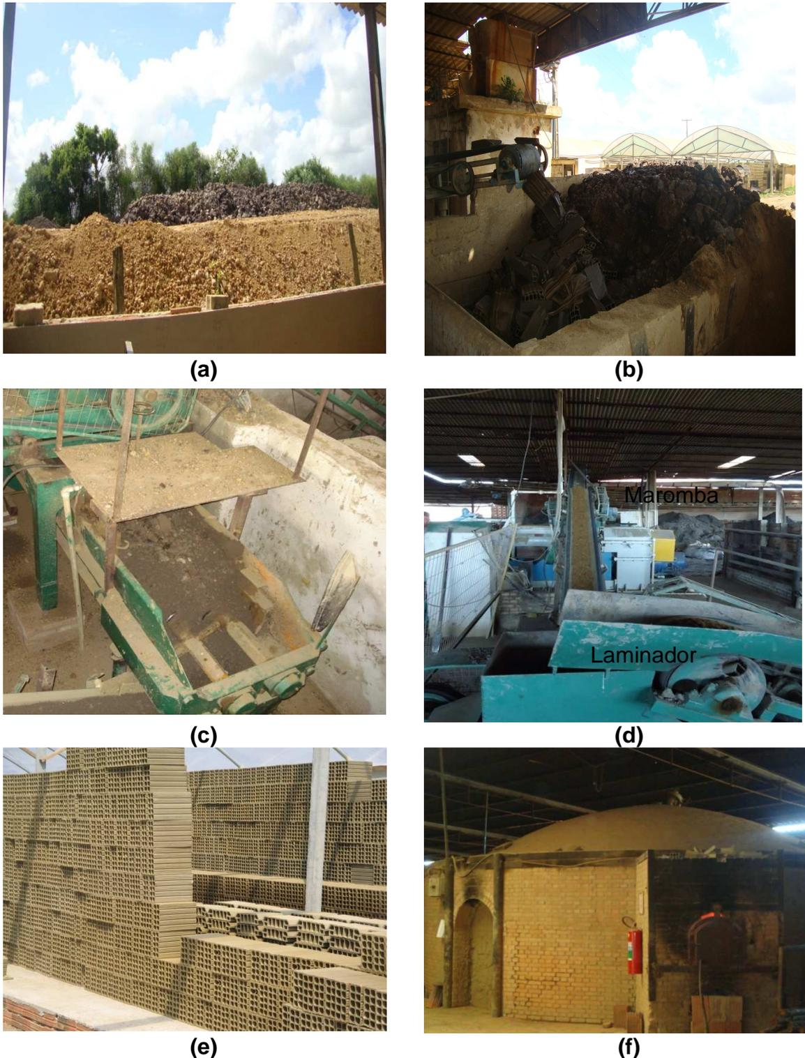
**Figura 4.14– Ilustração das etapas do processo de fabricação das indústrias cerâmicas (a) Sazonamento; (b) Caixão alimentador (desintegrador); (c) Misturador, (d) Laminador e Maromba; (e) Secagem e (f) Queima.**
