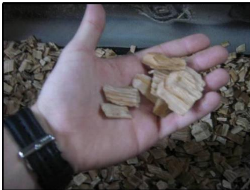
Figura 2. 11. - Cavacos de madeira de aproximadamente 1 cm preparados para produção de celulose (ABTCP, 2012).
