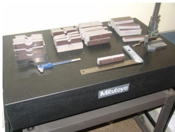
Figura 12: Mesa Mitutoyo para verificação das imperfeições nas faces dos corpos de prova.
