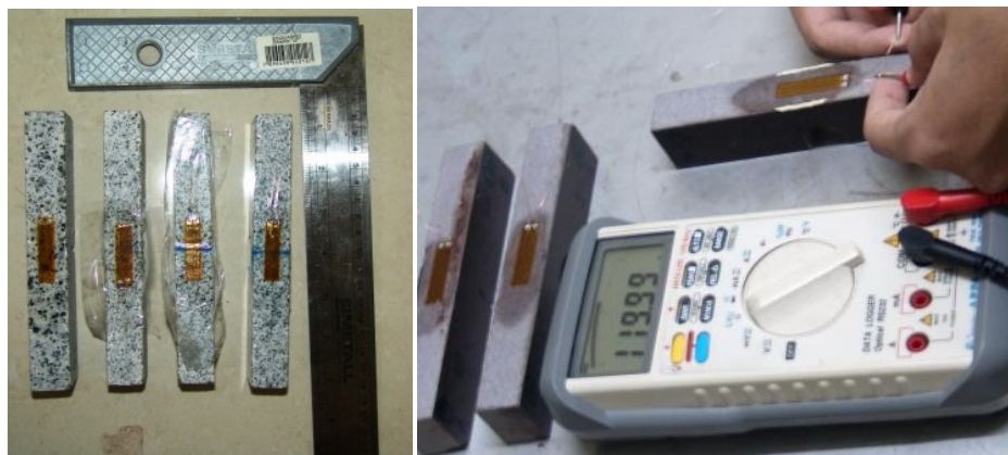
Figura 15: Corpos após a secagem e antes da retirada das fitas (esquerda) e teste de resistência (120 Ohms) dos SG após terem sido colados aos corpos de prova (direita).
