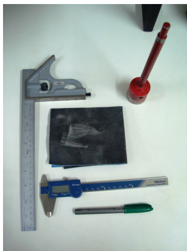
Figura 14: Materiais usados na preparação dos corpos de prova. Esquadro de metal, lixa, paquímetro, marcador e broca de Ø1,574”.
