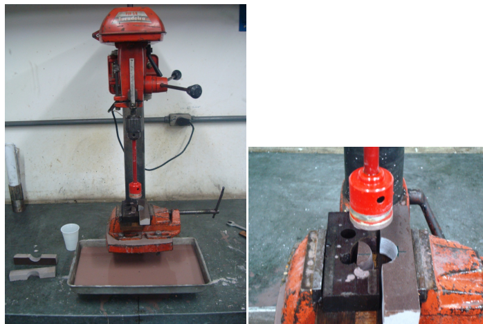
Figura 10: Aparato utilizado no corte semicircular dos corpos de prova. À esquerda furadeira e broca de 1,574” após perfurar um dos corpos de granito e à direita detalhe do entalhe semicircular pronto.
