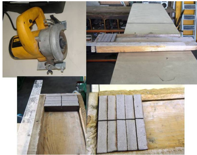
Figura 11: Serra utilizada no corte dos corpos de prova em U profundo e suporte de madeira para fixar os corpos de prova.
