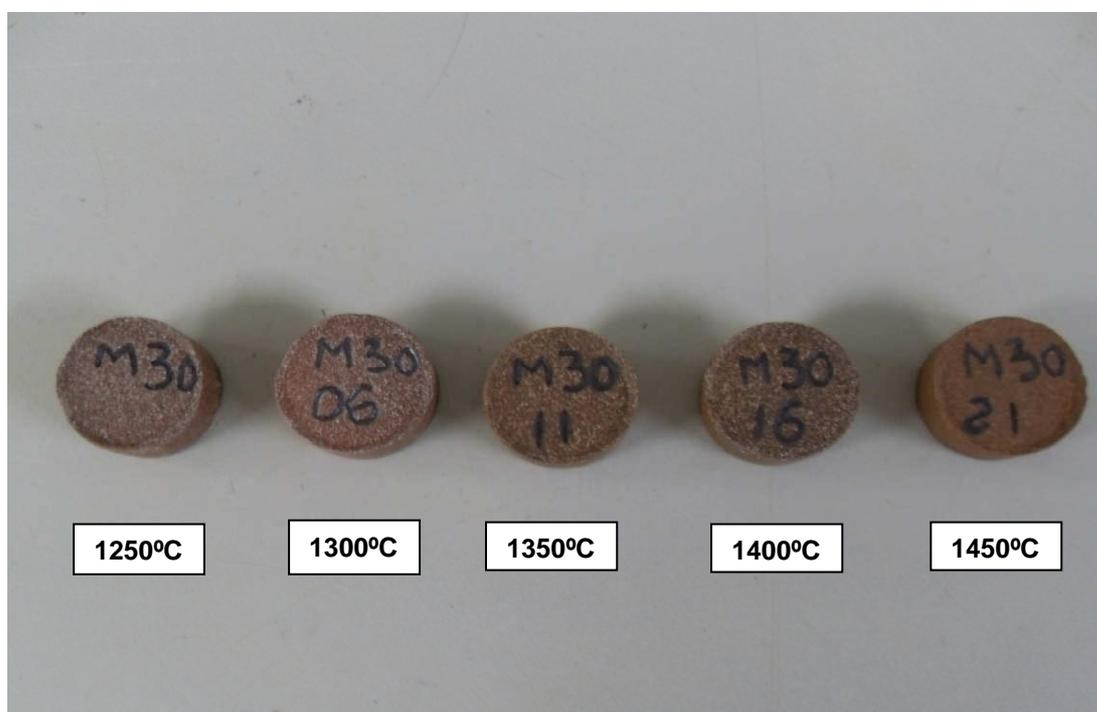
Figura 4.52 - Tonalidades das amostras M30, sinterizadas entre 1250°C á 1450°C.
