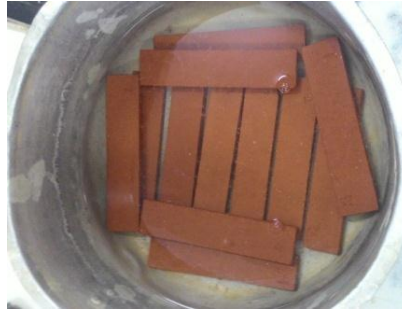
Figura 21: Ensaio de absorção de água (Acervo Pessoal, 2015).
