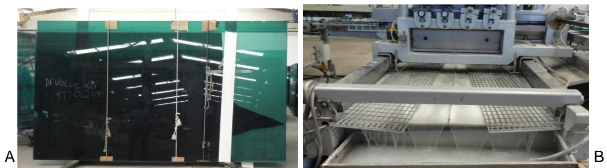
Figura 7: A) Chapas de vidro plano. B) Maquinário que lapida dois lados da chapa ao mesmo tempo (Acervo Pessoal).
