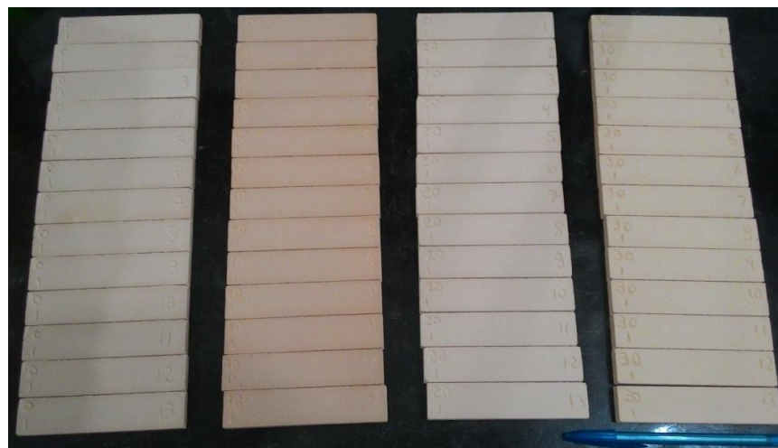
Figura 34: Corpos de prova das composições 0, 10, 20 e 30%, respectivamente, queimados a temperatura de 850°C (Acervo Pessoal, 2015).
