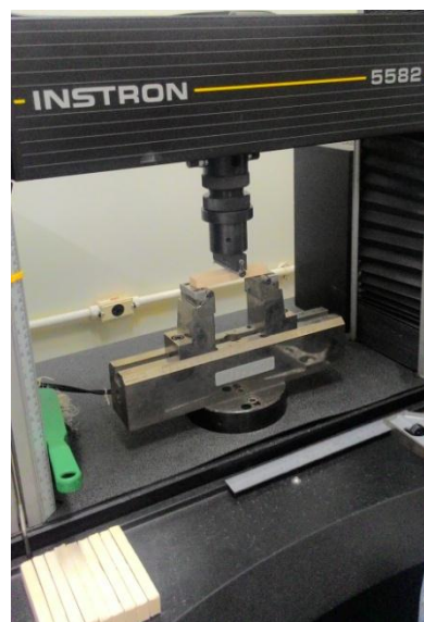
Figura 22: Ensaio de Tensão de Ruptura à flexão (Acervo Pessoal, 2015).
