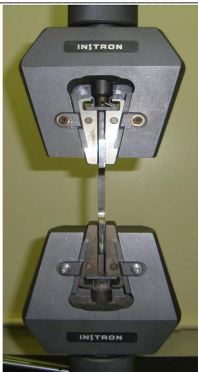
Figura 26: Corpo de prova preso na máquina para ensaio de tração.
