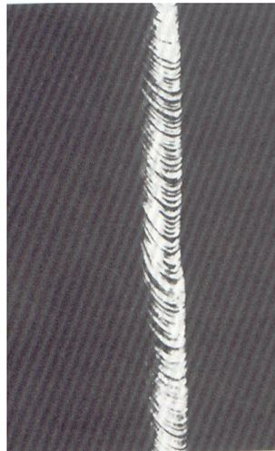
Figura 20: Deslizamento de um monocristal de zinco (Callister, 2002).
