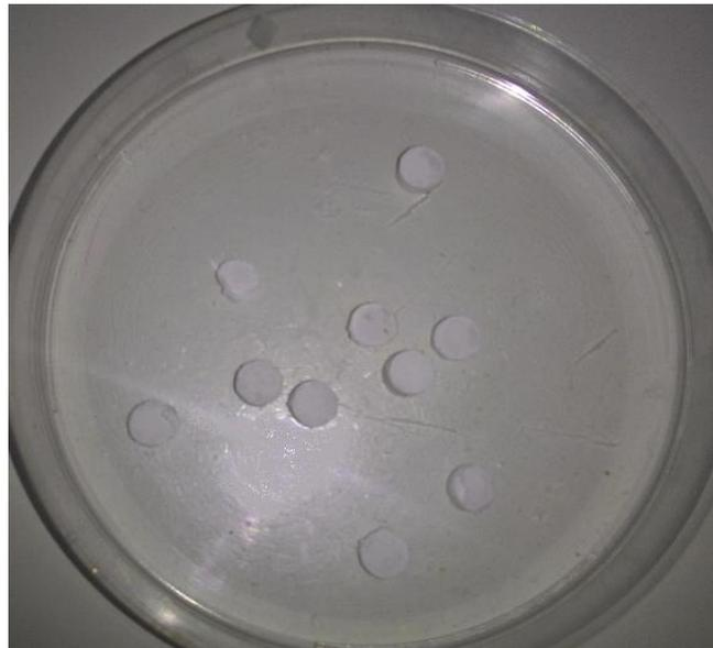
**Figura 3.11** – Corpos de prova do biocimento  $\beta$ -CPP
