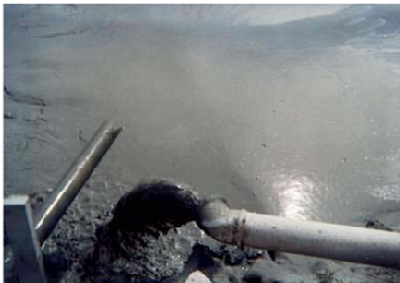
Figura 4.19 - Tubo de descarga do resíduo de corte de rocha ornamental (Pontes e Vidal, 2005)
