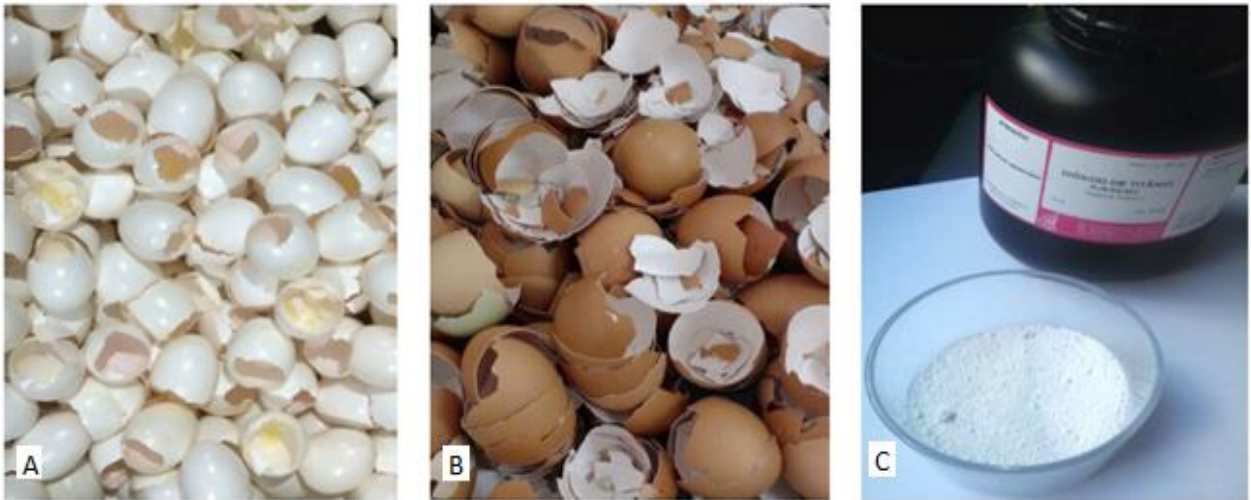
Figura 33: a) Resíduo de casca de ovo branco após ser coletado; b) Resíduo de casca de ovo marrom após retirada da membrana protetora; c) \text{TiO}_2 de origem comercial.
