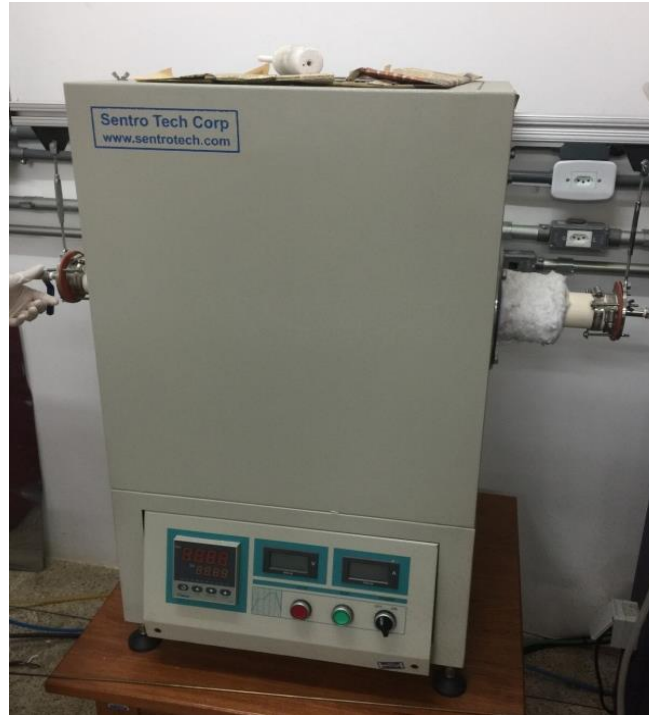
Figura 35: Forno de alta temperatura usado para síntese dos materiais.
