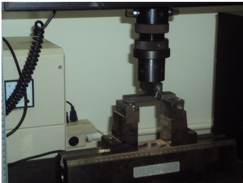
Figura 20. Ensaio de flexão de três pontos da pedra artificial
