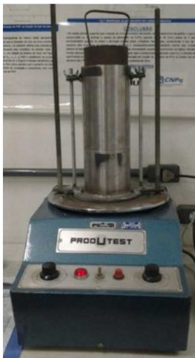
Figura 18. Aparato utilizado na determinação da densidade aparente seca das partículas de mármore
