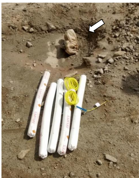
Figura 4: Na pedreira Itereré, a seta mostra uma perfuração para detonação desta quantidade de dinamites ilustrada.
