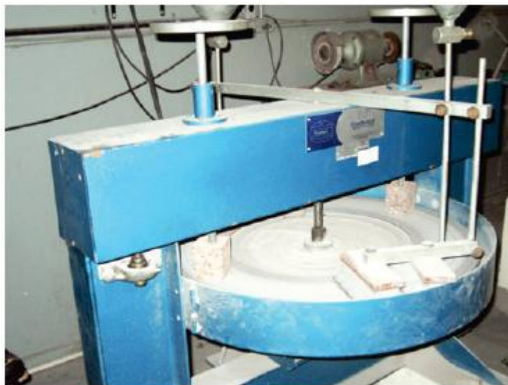
Figura 21. Equipamento de desgaste abrasivo do tipo Amsler (Costa et al. , 2014)
