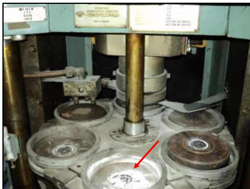
Figura 33 - Conjunto de dispositivos de alta pressão imediatamente após sinterização das amostras, com destaque em vermelho para a cápsula deformável de calcita explodida.
