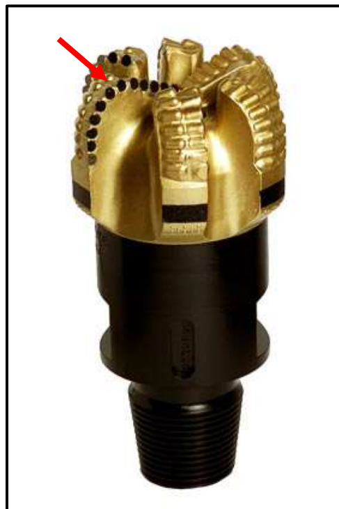
Figura 28 - Broca de 6 1/8" modelo STR386G23K utilizada na perfuração de poços de petróleo. (Extraído dos catálogos da Hughes Christensen Company ®, 1996).
