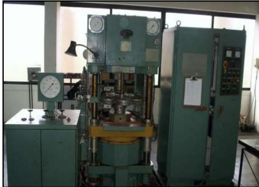
Figura 32 - Prensa de 630 t disponível no SMSD/LAMAV e utilizada na sinterização dos compósitos.
