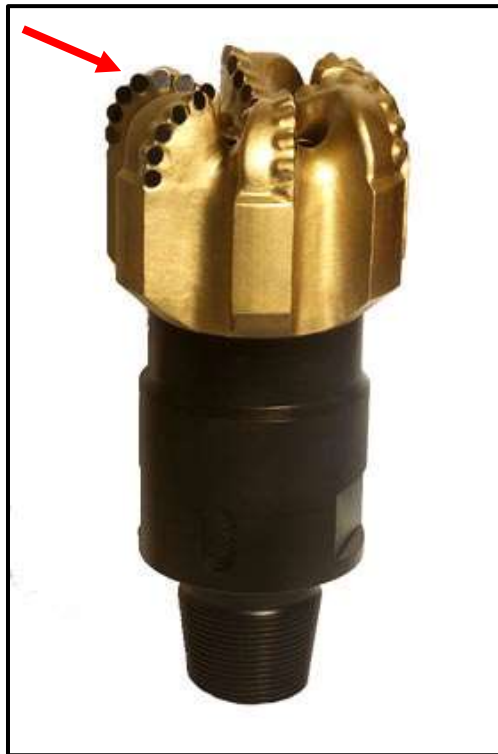
Figura 27 - Broca de 8 3/4" modelo R445XLC3 utilizada na perfuração de poços de petróleo. Detalhe em vermelho nos inserts de compósitos diamantados. (Extraído dos catálogos da Hughes Christensen Company ®, 1996).
