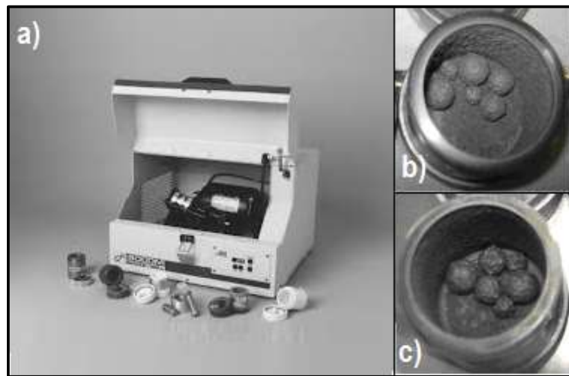
Figura 16 - Moinho do tipo SPEX 8000 (a) com acessórios e jarros após a moagem dos pós de Ti, Nb e Zr por: b) 50 min e c) 90 min, neste com exibição do efeito de soldagem. (Adaptado de Minatti et al. , 2012).
