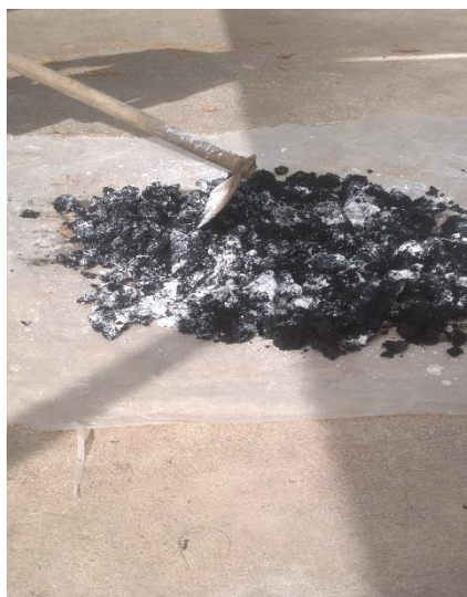
Figura 19. Caleação - processo de inertização do lodo de ETE.
