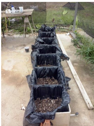
Figura 20. Caixas onde o lodo de ETE ficou armazenado após inertização.
