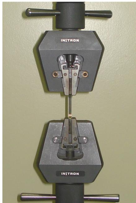
**Figura 16** - Corpo de prova preso à máquina
