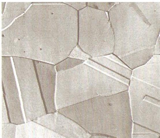
**Figura 1** – Microestrutura típica de um aço inoxidável austenítico (Callister, 2002)
