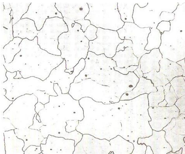
**Figura 2** – Microestrutura de um aço inoxidável ferrítico (Callister, 2002)
