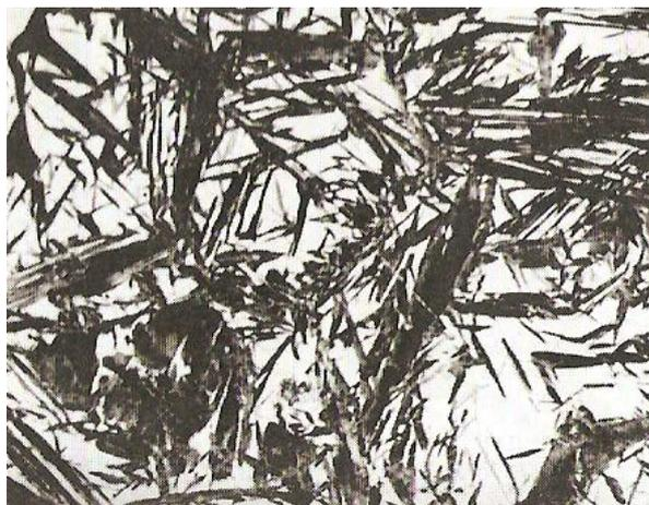
**Figura 3** - Microestrutura típica de um aço inoxidável martensítico (Callister, 2008)
