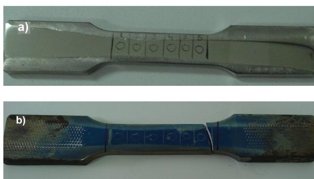
**Figura 30** – (a) corpo de prova antes do ensaio sem tratamento térmico, (b) corpo de prova após o tratamento térmico e ensaio de tração (650°C/8h)
