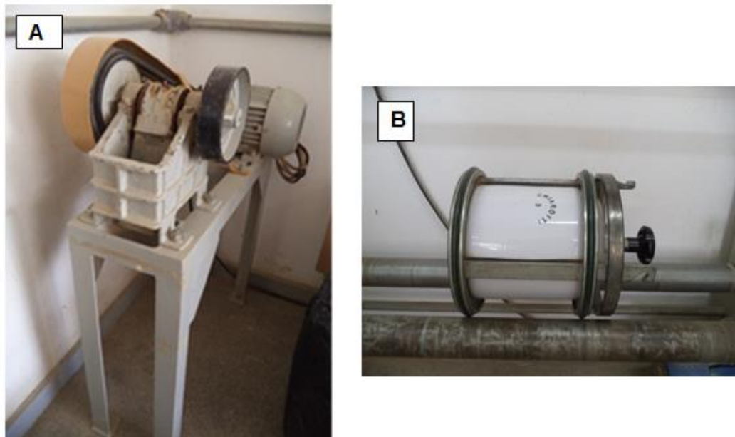
Figura 36: Equipamentos utilizados no beneficiamento das matérias primas: A-britador de mandíbulas e B-moinho de bolas (Fonte: Arquivo próprio).
