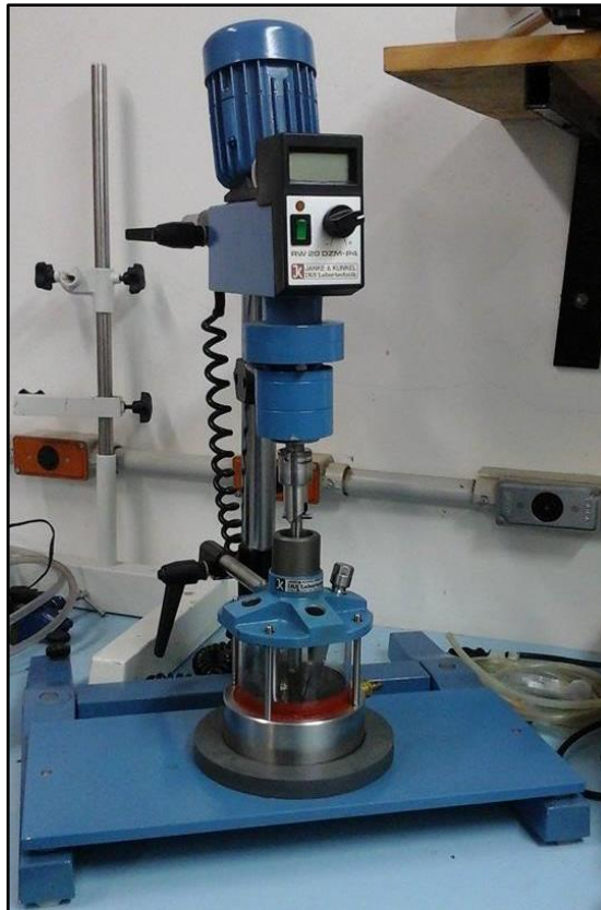
Figura 20: Reator IKA-250 usado para estabilizar a magnetita com ácido oleico
