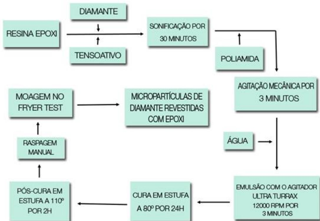
Figura 22 - Fluxograma do processo de recobrimento do diamante pela técnica de emulsão epóxi em água (Ing et al, 2015) Adaptado.
