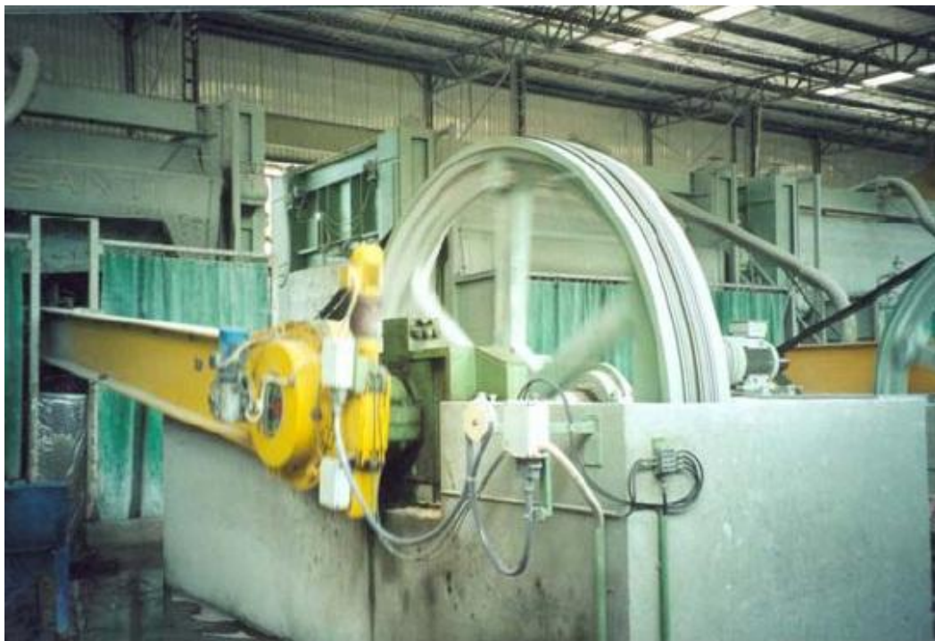
Figura 4.3. Tear moderno de grande porte. Empresa Marbrasa (Cachoeiro de Itapemirim-ES)
