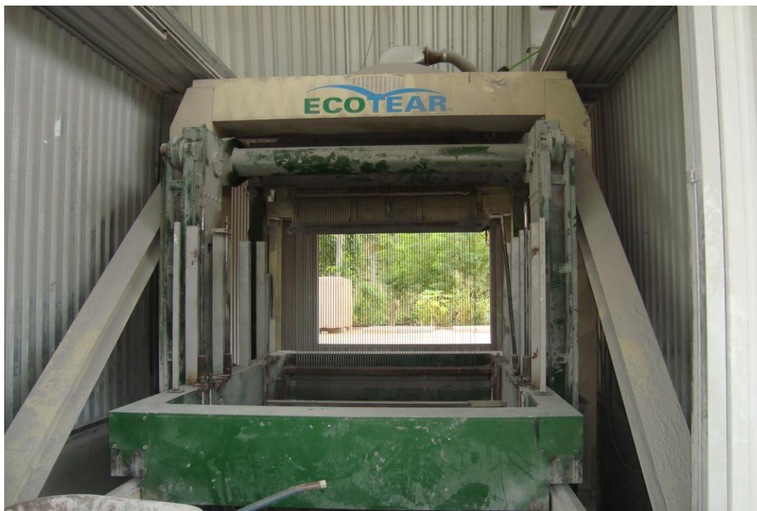
Figura 4.4. Tear com corte a seco (Ecotear)
