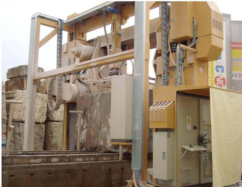
Figura 5.2. Tear de multifios diamantados. Pemagran Pedras e Mármore LTDA
