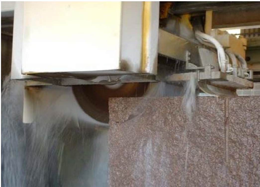
Figura 4.5. Talha-blocos para produção de ladrilhos (Granitos Brasileiros S.A)
