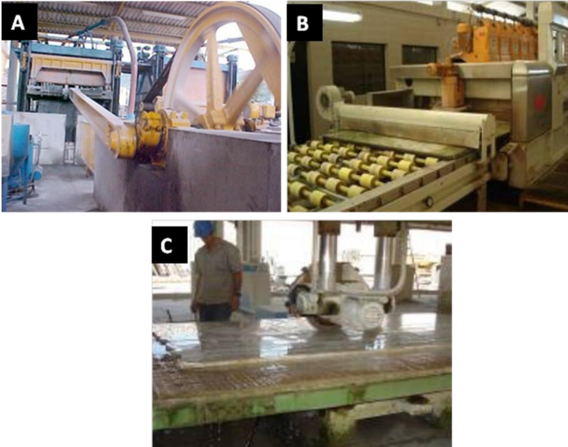
Figura 4.11. Processos de beneficiamento. (a) Desdobramento, (b) polimento, corte e (c) acabamento
