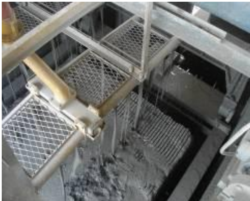
Figura 4.8. Lama abrasiva sendo lançada sobre bloco de granito.
