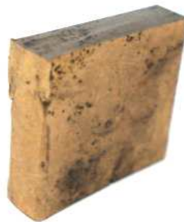
Figura 31 - Barra da liga policristalina Cu-Al-Ni (CANP-3) como recebida (25x25x5mm).
