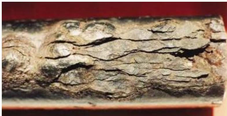
**Figura 2.7: Corrosão por esfoliação.**
