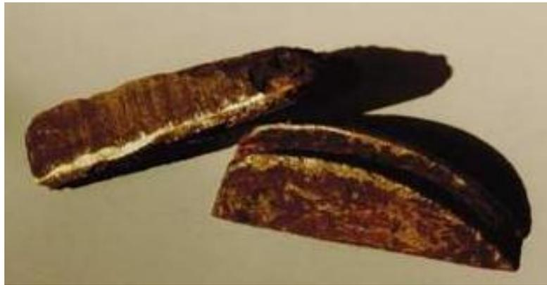
**Figura 2.8: Corrosão gráfitica no ferro fundido.**
