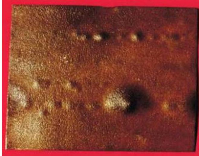
**Figura 2.11: Metal com empolamento pelo hidrogênio.**
