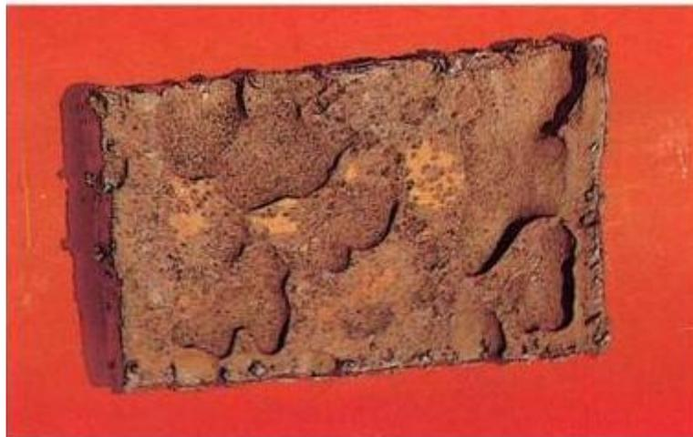
**Figura 2.3: Corrosão por placas.**
