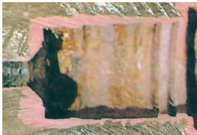
**Figura 2.9: Corrosão por dezincificação no latão.**
