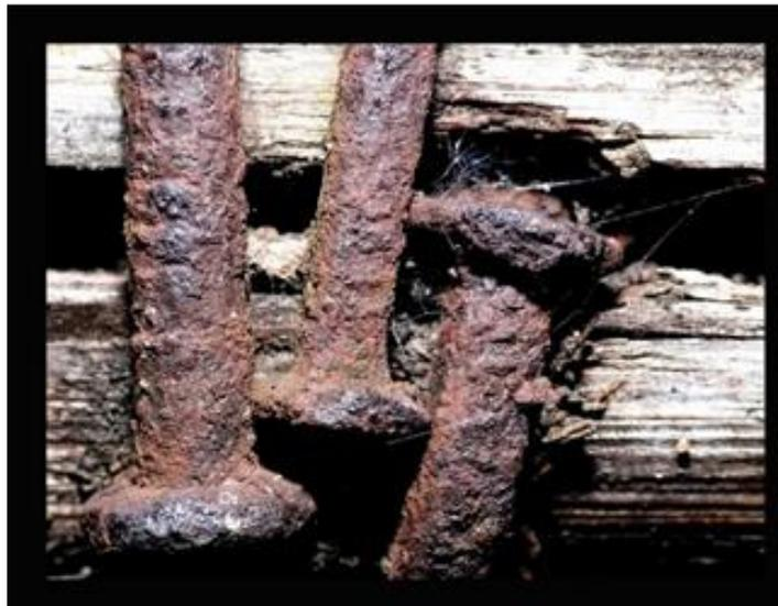
Figura 2.1: Corrosão uniforme.
