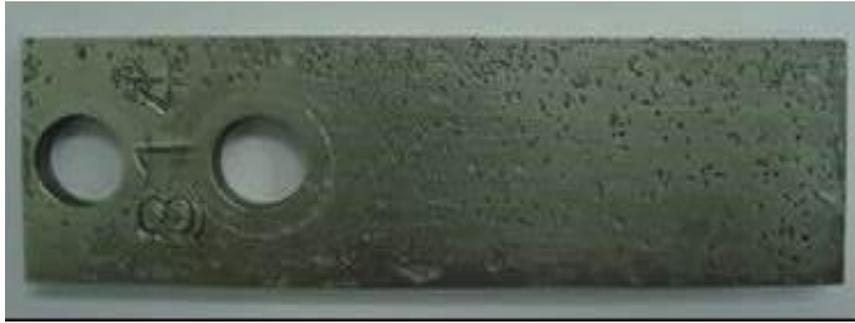
**Figura 2.4: Corrosão por pites.**
