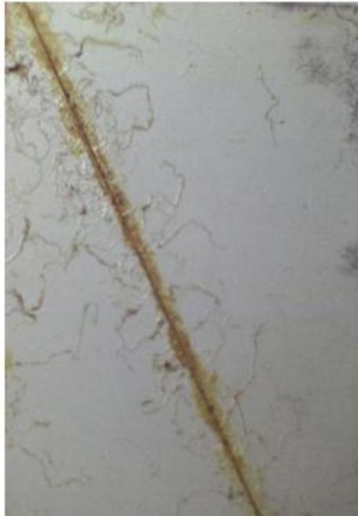
**Figura 2.10: Exemplo de uma superfície que apresenta corrosão filiforme.**
