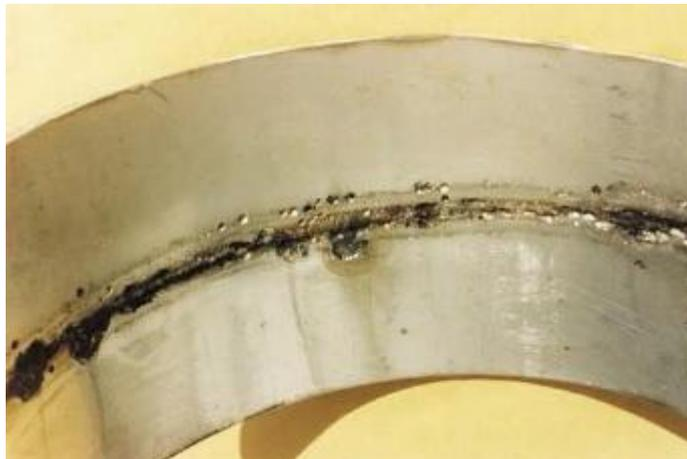
**Figura 2.12: Corrosão em torno do cordão de solda.**
