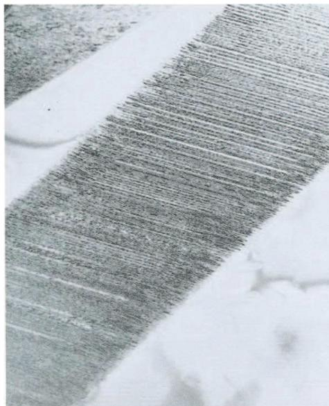
Figura 11. Estrutura finamente maclada de uma martensita de placa fina em um aço contendo 1,4%C (Christian, 2002).
