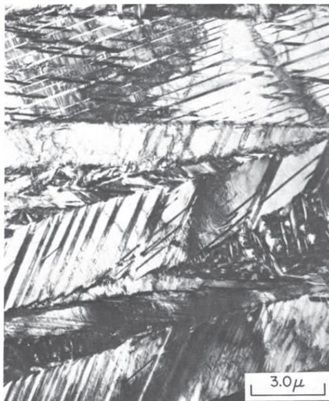
Figura 13. Martensita ortorrômbica na liga Ti-4,25%Mo-0,5%Si, temperada a 950°C (Williams e Hickman, 1970).
