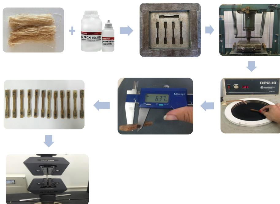
**Figura 39** - Organograma com o procedimento para fabricação dos corpos de prova de fibra de curauá para ensaio de tração.
