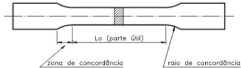
**Figura 37** - Corpo de prova para ensaio de tração (Dalcin, 2007).
