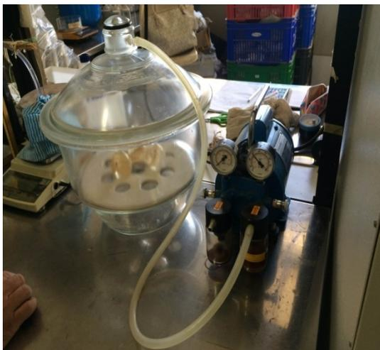
**Figura 34** - Dessecador ligado à bomba a vácuo (LAMAV/UENF)
