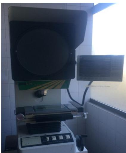
**Figura 31** - Projetor de Perfil Nikon, utilizado para medir o diâmetro das fibras de curauá (LAMAV/UENF)
