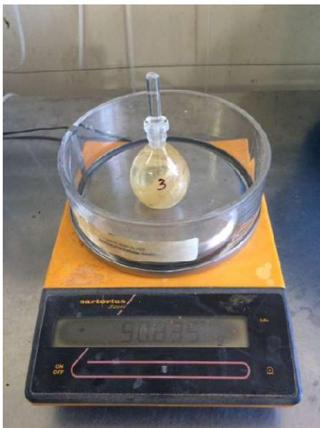
**Figura 35** - Massa do picnômetro + água + fibra (LAMAV/UENF)
