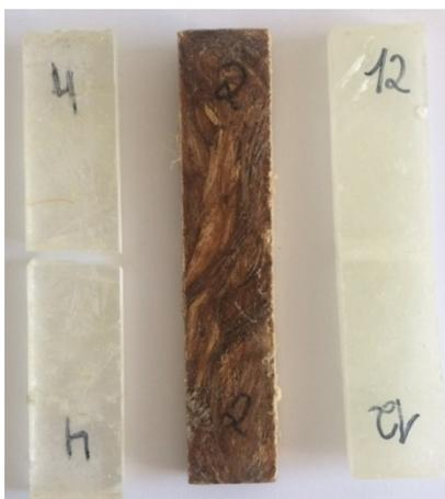
**Figura 53** - Macro Aspecto dos corpos de prova após ensaio de flexão: 0%, 30% fibra de curauá e 30% fibra de vidro respectivamente
