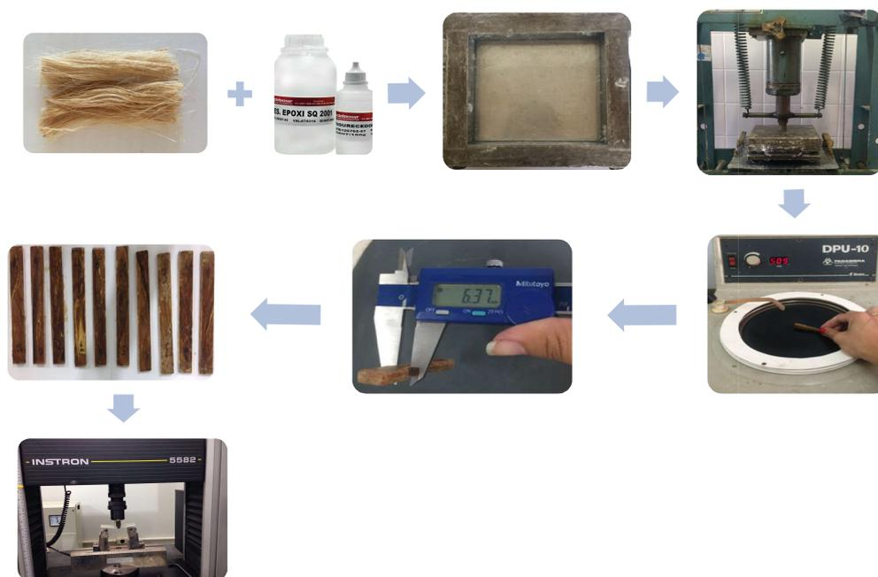
**Figura 41** - Organograma do procedimento para fabricação dos corpos de prova de fibra de curauá para ensaio de flexão
