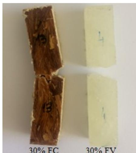
**Figura 61** - Aspectos macroestruturais por impacto Izod de compósitos de matriz epoxídica reforçados com 30% FC e 30% FV
