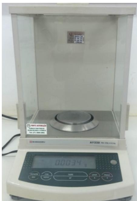
**Figura 32** - Balança de precisão digital (LAMAV/UENF)
