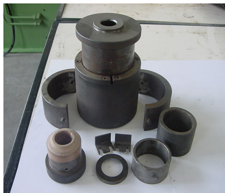
Figura 10 – Matriz de compactação (a) e prensa utilizada para compactação (b).
