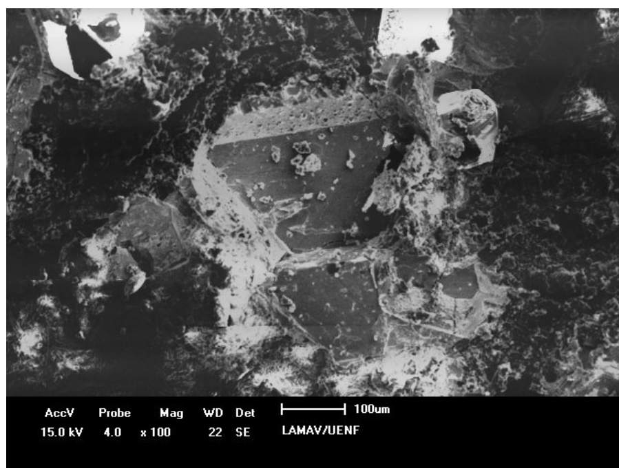
Figura 34 – Região de fratura do aglomerado obtido com adição de 5% de ferro
