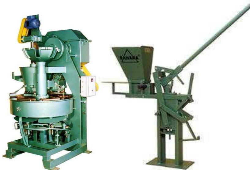
**Figura 2.11 – Prensas mecânicas disponíveis no mercado para a produção de tijolos solo-cimento. Prensa automática (a) e manual (b) (Destefani, 2009).**
