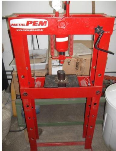
**Figura 3.2. Prensa hidráulica utilizada na confecção dos corpos cimentícios (Rodrigues, 2012).**
