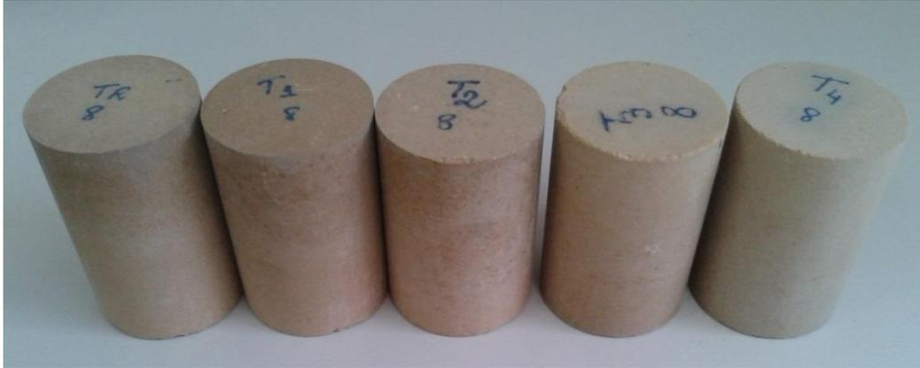
**Figura 4.13 – Corpos-de-prova incorporados com 0, 10, 20, 30 e 40 % de resíduo, respectivamente.**
