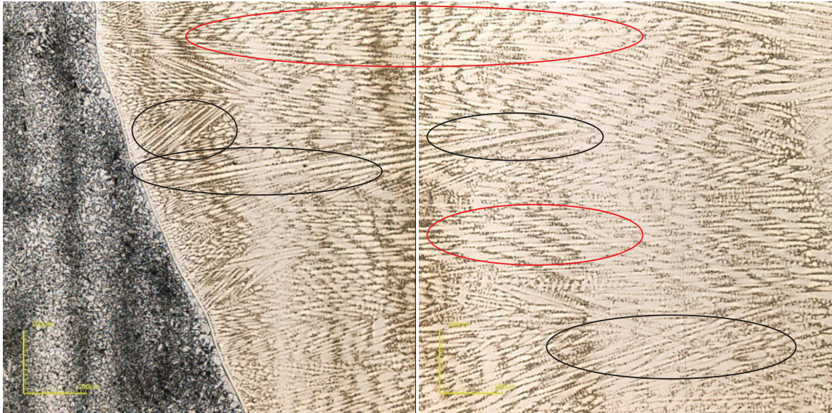
Figura 32. Crescimento dendrítico na solidificação do revestimento. EM vermelho: Crescimento dendrítico-celular e em preto: crescimento dendrítico-colunar. Ataque eletrolítico com ácido oxálico 10%. MO: Confocakl. Aumento:430x.
