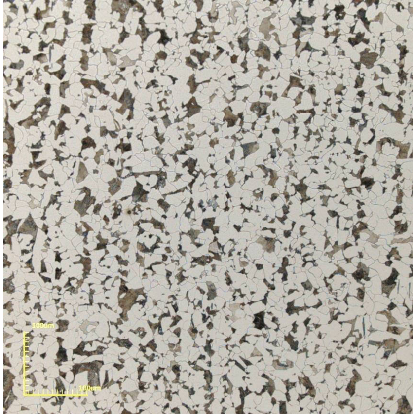
Figura 39. Microestrutura do MB normalizado à 950°C por 60 minutos. MO: Confocal. Aumento: 430x.
