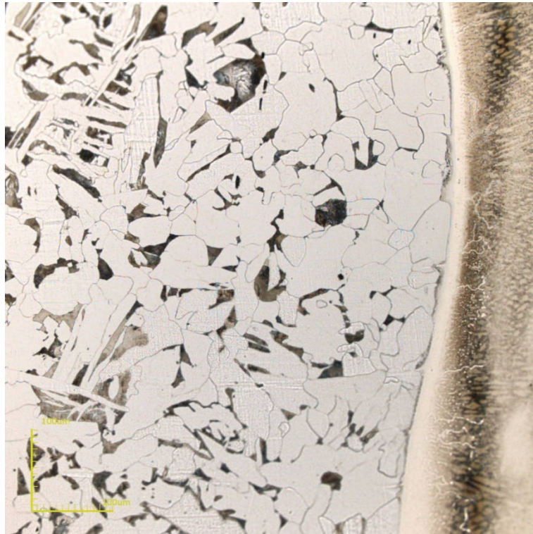
Figura 52. Interface entre MB e revestimento após tratamento térmico à 1100°C por 60 minutos. Ataque eletrolítico com ácido oxálico 10%. MO: Confocal. Aumento: 430x.
