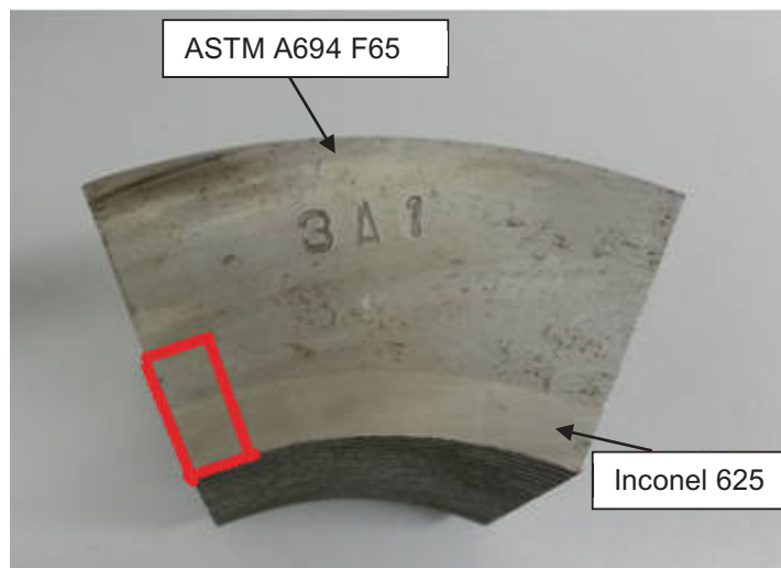
Figura 20. Corte da amostra com direção transversal à de conformação.
