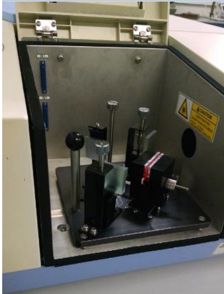
Figura 10: Equipamento infravermelho (FTIR) com acessório ATR.
