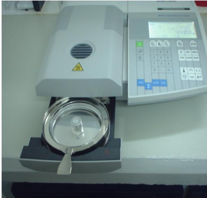
Figura 12: Equipamento Halogen Moisture Analyzer modelo HR73 da Mettler Toledo.
