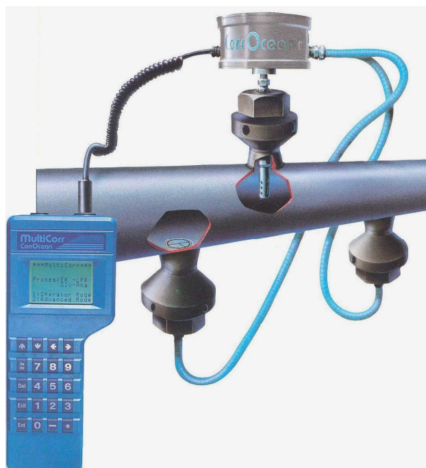
Figura 19: Ilustração esquemática da monitoração de corrosão em sistema de injeção de água (Silva et al, 2007).
