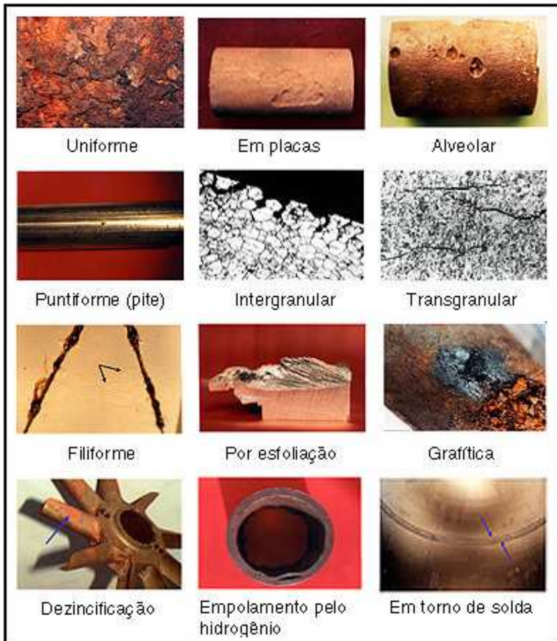
Figura 6: Formas de corrosão (Gentil 2003).
