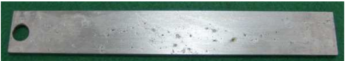
Figura 29: Fotos dos tipos de corpos de prova utilizado na célula de corrosão durante ensaios, antes da exposição ao fluido (1), com produtos de corrosão aderido (2) e corroído após decação química para retirada dos resíduos de corrosão (3).
