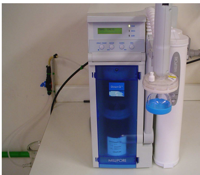
Figura 26: Fotografia do sistema de filtração da água – Millipore Direct-Q, para preparação de água filtrada tipo III.
