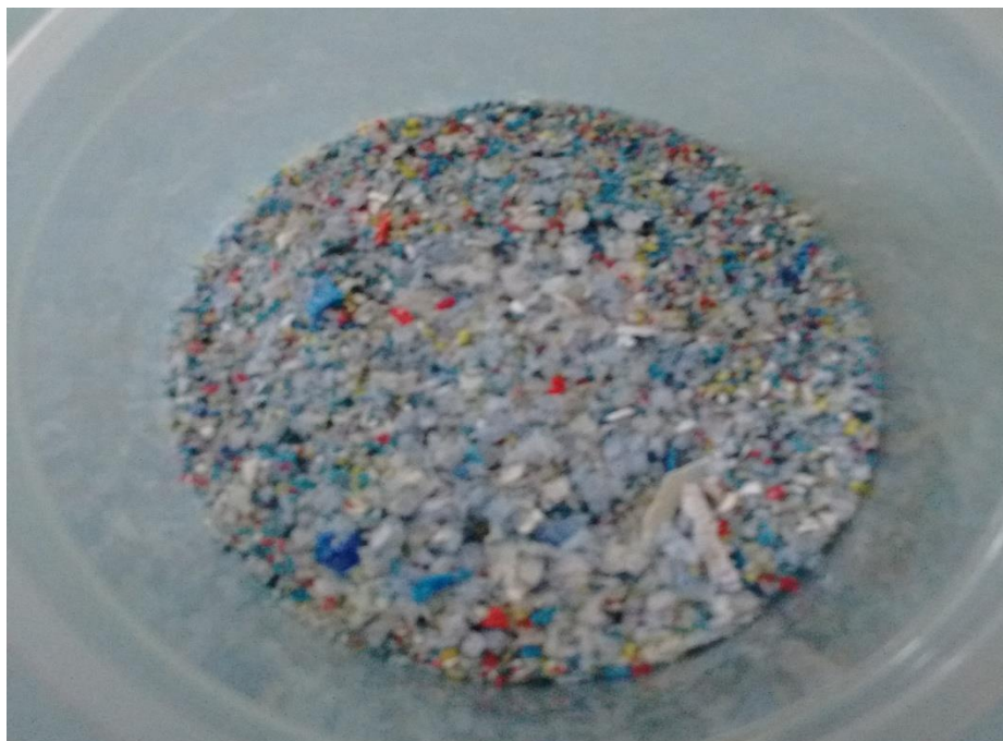
Figura 20: PP pós-consumo cortado no moinho de faca
