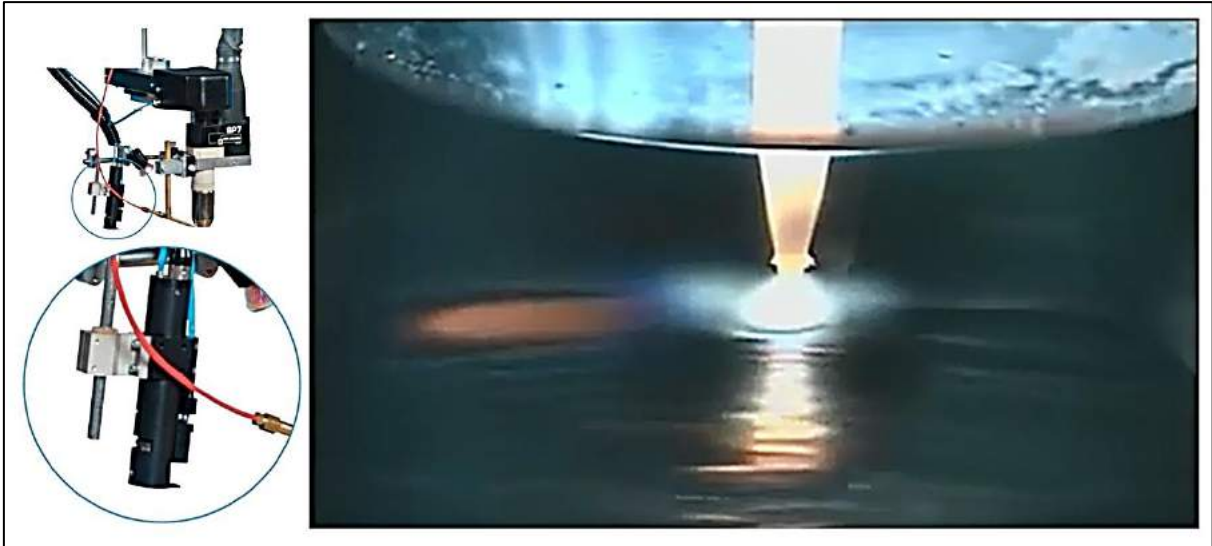
Figura 64. Soldagem TIG com Câmera de Vídeo (“ visioarc ”), adaptado de (SAF, 2014.)
