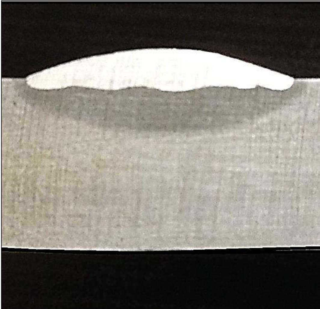
Figura 69. Macrografia de um cordão de solda, pelo autor.
