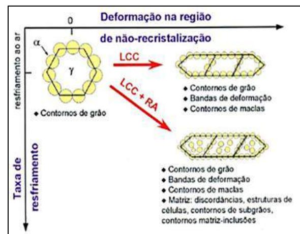
Figura 21. Efeito da laminação e do resfriamento sobre sítios de nucleação na transformação da austenita (Araújo, et al , 2008.)
