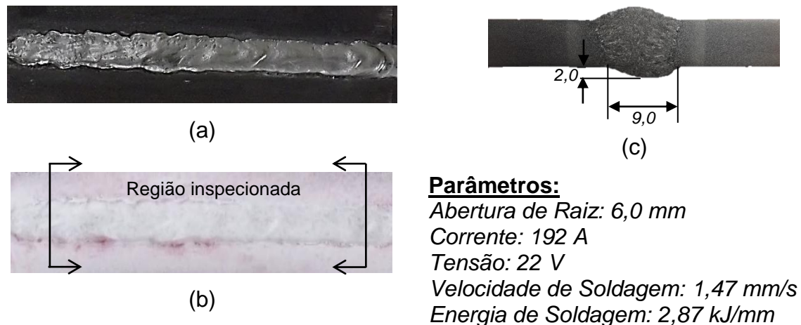
Figura 57 – Resultados da formulação semi-básica 12, parâmetros D. (a) Inspeção Visual, (b) LP e (c) Macrografia.
