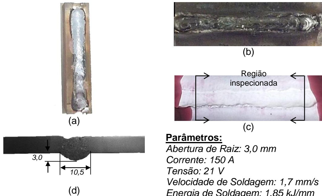
Figura 39 – Resultados da Formulação 5. (a) Suporte cerâmico, (b) Inspeção visual, (c) Líquido Penetrante, (d) Macrografia.
