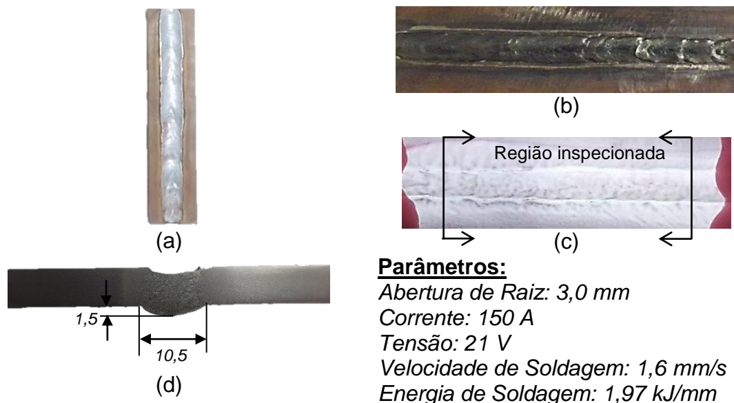
Figura 42 – Resultados da Formulação 8. (a) Suporte cerâmico, (b) Inspeção visual, (c) Líquido Penetrante, (d) Macrografia.
