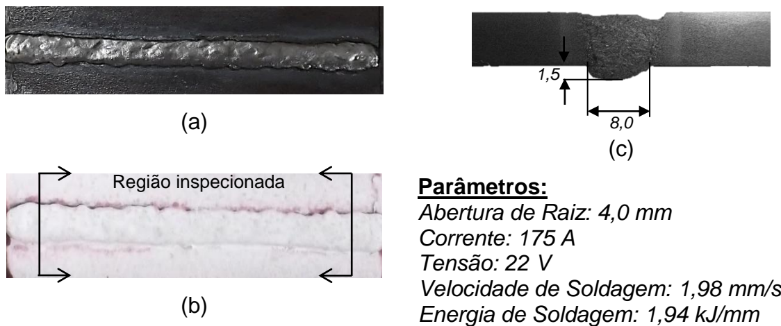
Figura 56 – Resultados da formulação semi-básica 12, parâmetros C. (a) Inspeção Visual, (b) LP e (c) Macrografia.
