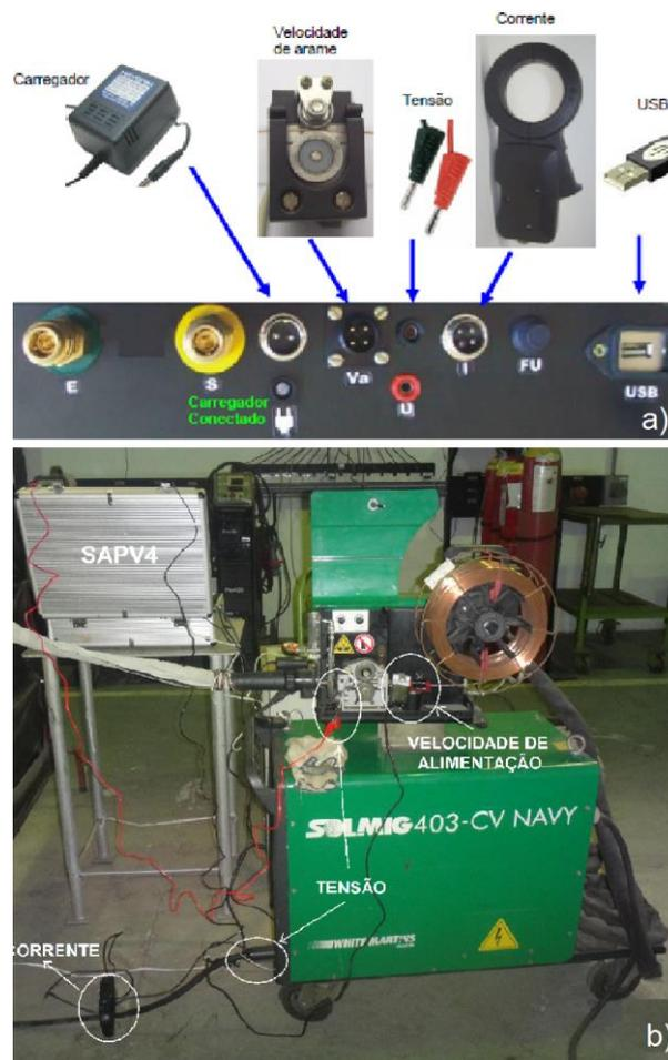
Figura 28: a) Painel de conexões do SAPV4 e respectivos dispositivos. b) Dispositivos do SAPV4 acoplados à máquina de solda.
