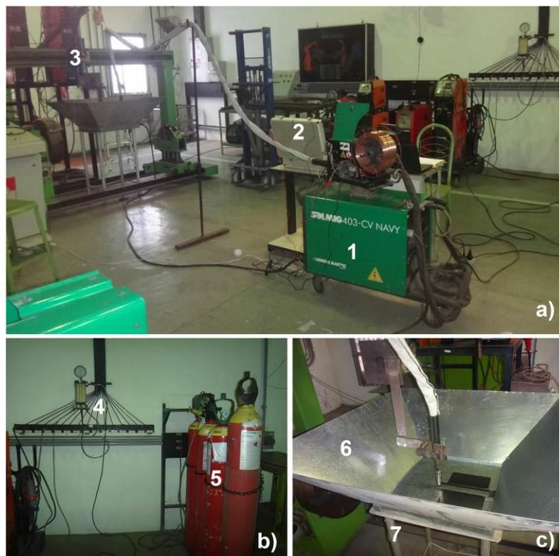
**Figura 27: a) Disposição dos equipamentos. b) Misturador de gases e cilindros utilizados. c) mesa de soldagem e coletor de respingos.**
