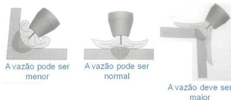
**Figura 14: Influência da configuração da junta na regulação da vazão do gás de proteção.**
