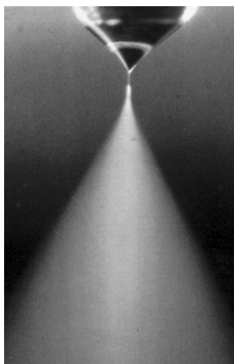
Figura 2.35: Atomização da solução precursora em forma de cone. Adaptada de (Perednis et al. , 2005).
