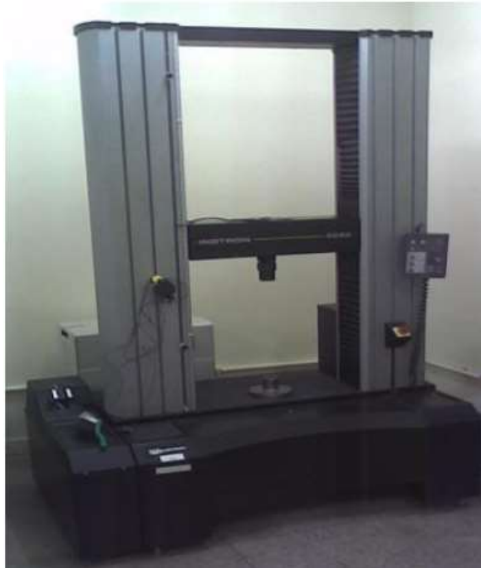
Figura 27 - INSTRON modelo 5582, LAMAV/UENF (Fonte própria).
