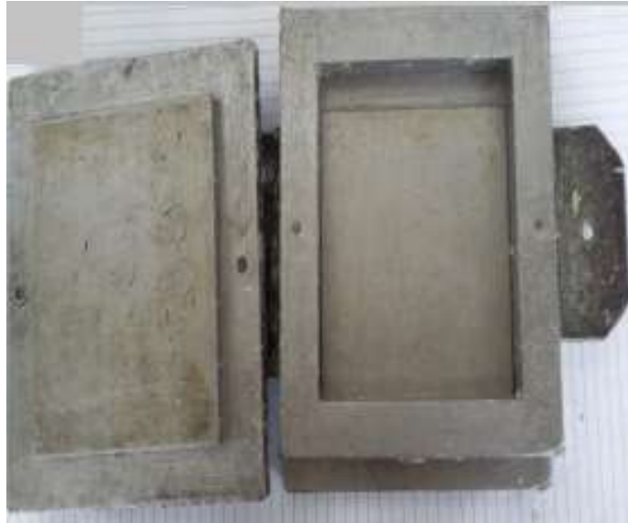
Figura 25 - Matriz metálica utilizada para a produção de placas utilizadas na fabricação de corpos de prova para ensaio de impacto (Adaptado de Gomes, 2015).
