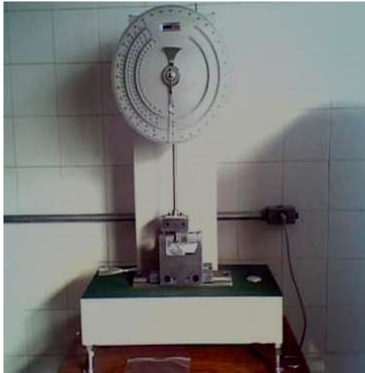
Figura 29- PANTEC pendulum, modelo XC-50 do LAMAV/UENF (Fonte própria).
