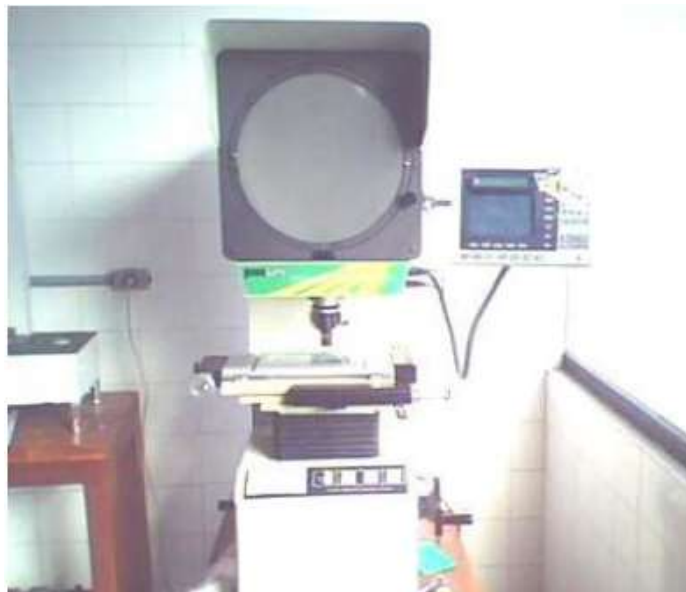
Figura 20- Projetor de perfil Nikon, utilizado para medir os diâmetros das fibras (Fonte própria).
