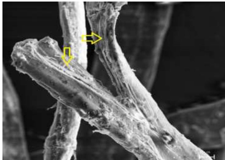
Figura 31 - Micrografia da superfície da fibra de hemp , na região da fratura (Fonte própria).
