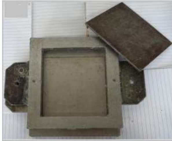
Figura 24 - Matriz metálica utilizada para fabricação de corpos de prova para ensaios de flexão (Adaptado de Gomes, 2015).
