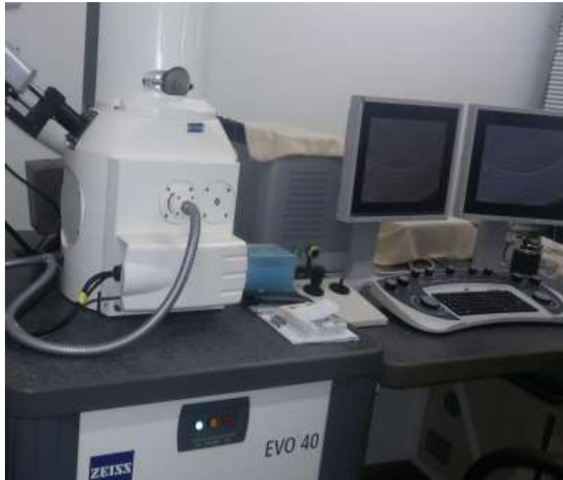
Figura 22 - Microscópio Eletrônico de Varredura (MEV), ZEISS EVO 40 do LBCT/UENF (Fonte própria).
