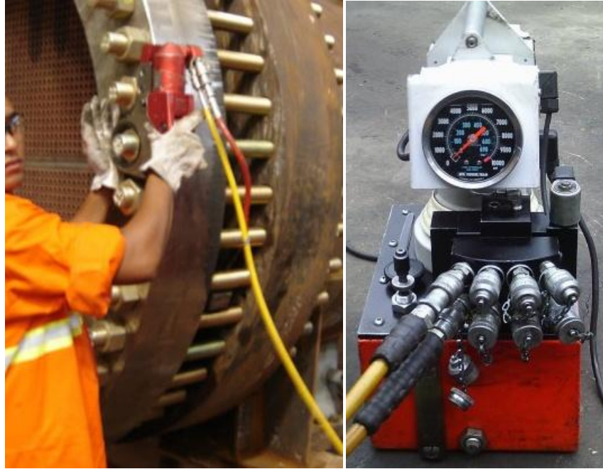
Figura 2.12 – Aplicação hidráulica de torqueamento com bomba e chave (www.alimaqmix.com.br).
