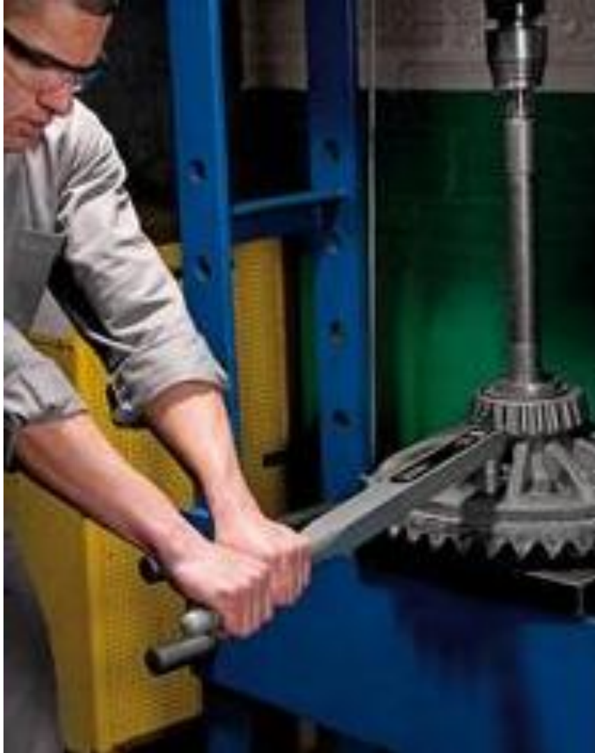
Figura 2.11 – Aplicação manual de torqueamento. ( www.fattocom.com.br ).
