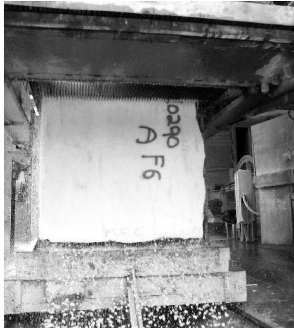
Figura 10 – Tear de Lâminas Diamantadas.
