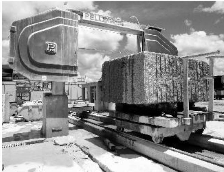
Figura 11 – Monofio para Esquadreamento de Blocos.
