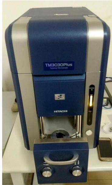
Figura 24 – Microscópio Eletrônico de Varredura (MEV).
