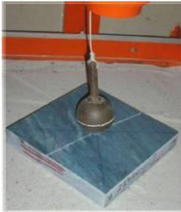
Figura 23 – Corpo de Prova Rompido pela Queda da Esfera de Aço.
