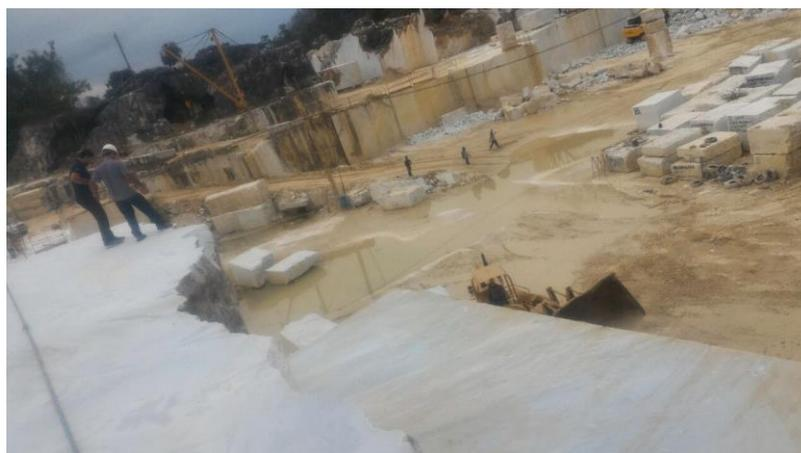
Figura 8 – Lavra de Marmo-Ônix Blue em Gironda, Corte por Fio Diamantado.
