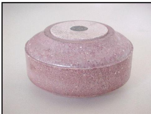
**Figura 29** – Fotografia da cápsula deformável montada.
