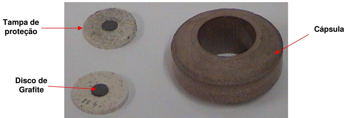
**Figura 27** – Cápsula deformável e seus respectivos componentes.
