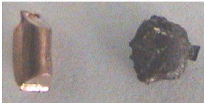
**Figura 47** – Amostra de cobre (Cu) antes e após a fusão.
