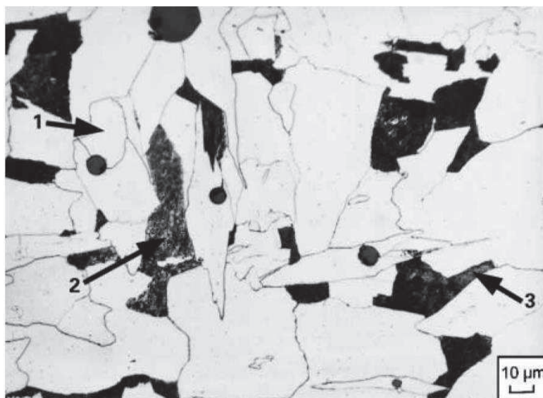
Figura 35 – 1) ferrita idiomórfica, 2) agregado de ferrita e carbeto, 3) perlita indecifrável (Thewlis, 2004).
