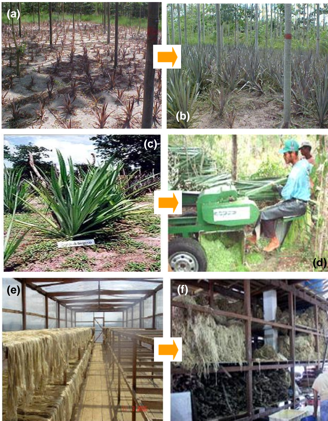
Figura 4 – Processo de Fabricação do curauá: plantação de curauá (a) com 6 meses; (b) com 18 meses (c) tamanho adulto pronto para a colheita (d) batelamento das folhas (e) fibra extraída e secando (f) armazenada pronta para a venda. (Pematec Triangel do Brasil Ltda, 2005)
