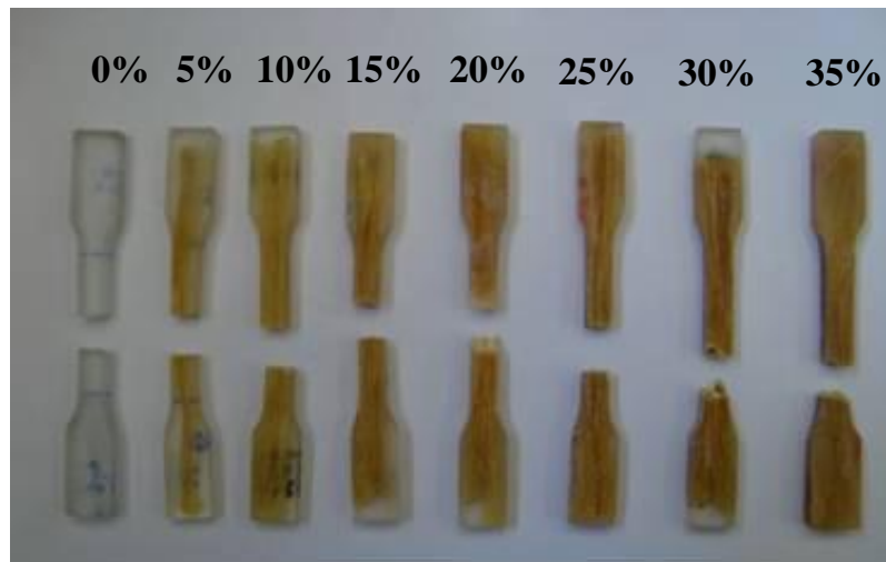
Figura 49 – Amostras de tração rompidas para cada fração em volume de fibra de curauá incorporada na matriz de epóxi.
