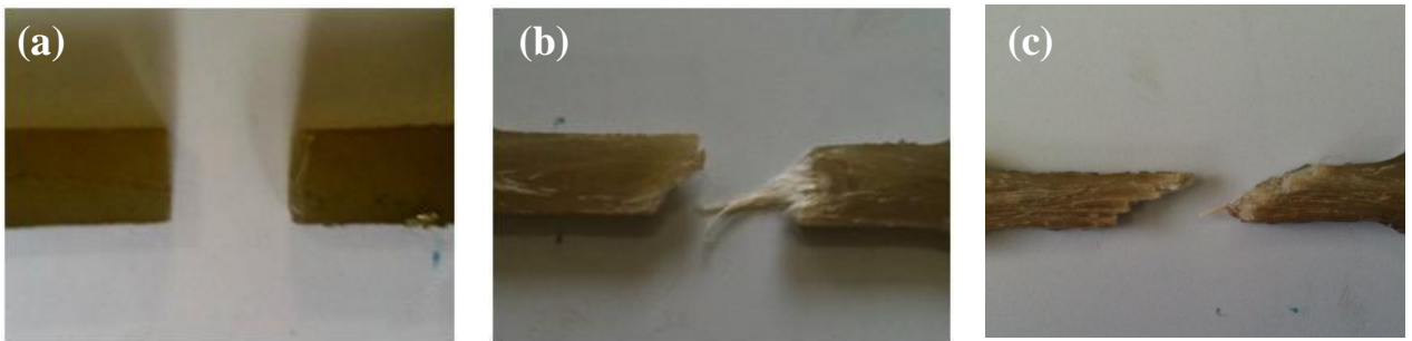
Figura 46 – Fratura da ponta dos compósitos de poliéster rompidos com (a) 0%, (b) 20% e (c) 40% de fração em volume de fibras de curauá.
