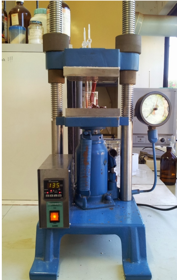
Figura 20 Prensa hidráulica para moldagem dos corpos de provas.
