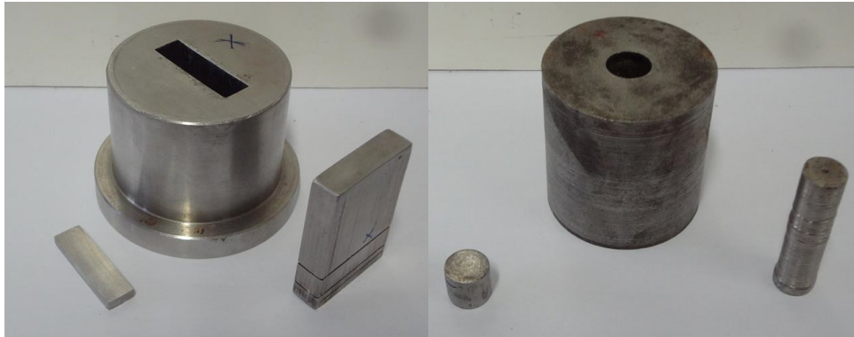
Figura 23 Moldes metálicos para a confecção dos corpos de prova, em aço inoxidável e comum, respectivamente.
