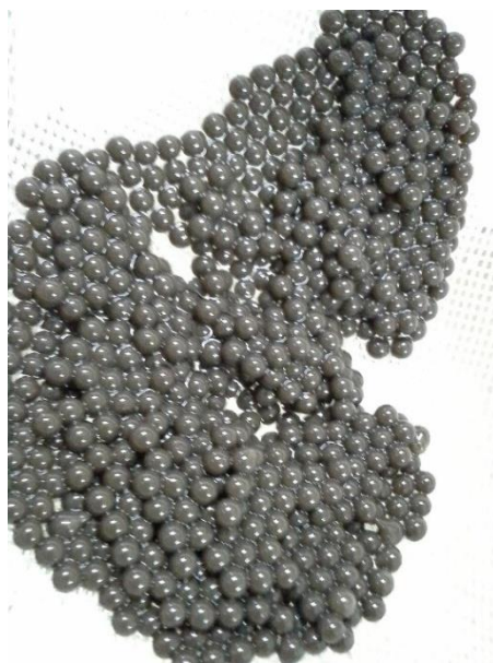
Figura 52 – Imagem das esferas de QTS/ \text{Fe}_3\text{O}_4 após o processo de modificação com EPC.
