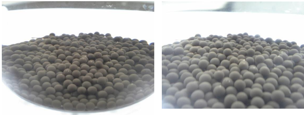
Figura 51 – Imagens de esferas de quitosana – magnetita em solução de hidróxido de sódio
