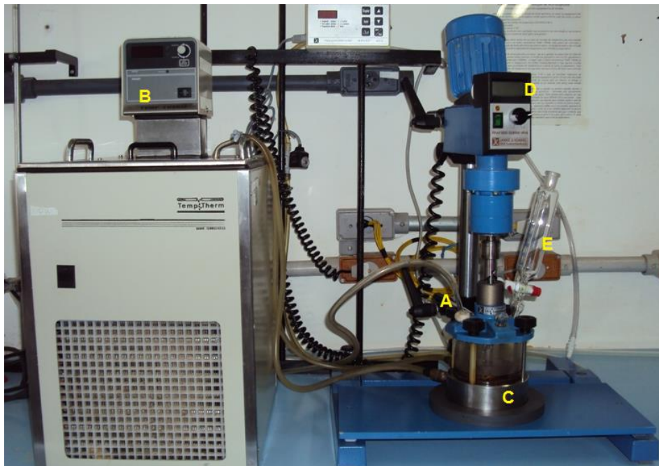
Figura 33 – Reator IKA-250 localizado no setor de polímeros LAMAV
