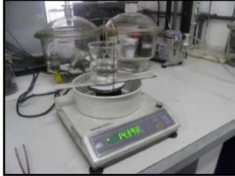
**Figura 21** - Montagem para medição de densidade por Arquimedes.
