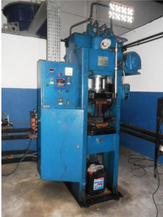
**Figura 18** - Prensa hidráulica EKA modelo PHB30.REF220 (Abrasdi, 2015).
