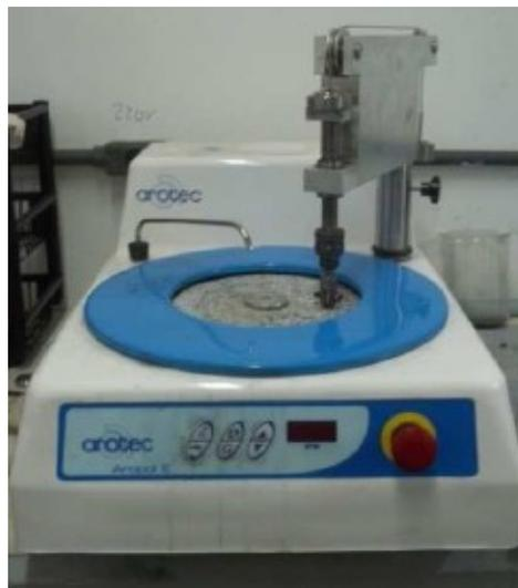
**Figura 24** - Abrasimetro adaptado para ensaio de desgaste (LAMAV/CCT/UENF).
