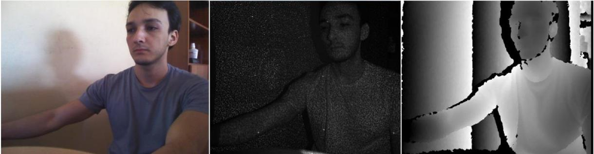
**Exemplo de mapa de profundidade obtido através de luz infravermelha estruturada. Na esquerda a imagem da câmera RGB, no centro a imagem recebida da câmera infravermelho e o mapa de profundidade na direita. Fonte: (Próprio autor)**
