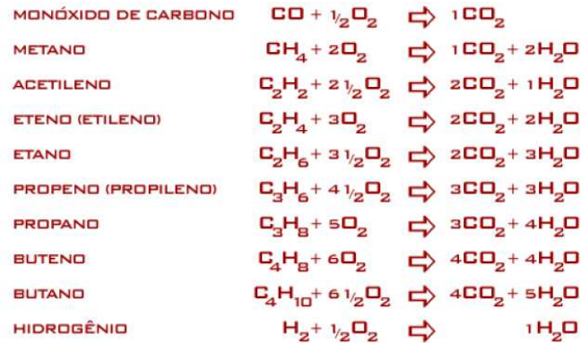
Figura 3.12 – Principais reações da combustão estequiométrica de gases combustíveis (Córner, 2012)
