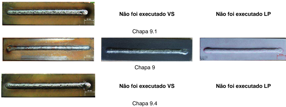
Figura 5.14 – Chapas 9.1, 9 e 9.4 após soldagem com Ar+25\%CO_2+6\%H_2 , após preparação para ensaio visual e após ensaio por líquido penetrante.
