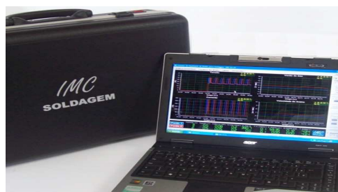
Figura 3.7 – Sistema SAP 4.01 de aquisição de dados de soldagem (IMC Soldagem, 2005)
